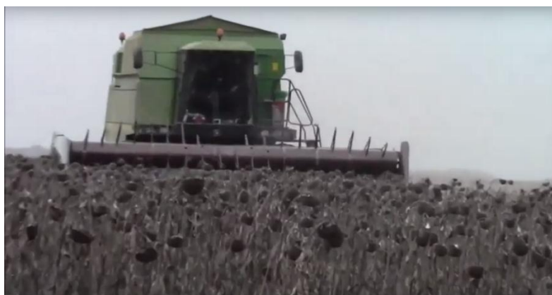
Рис. 2.12. - Комбайн «JohnDeer 2066» з пристосуванням ПС-6,1А-06
