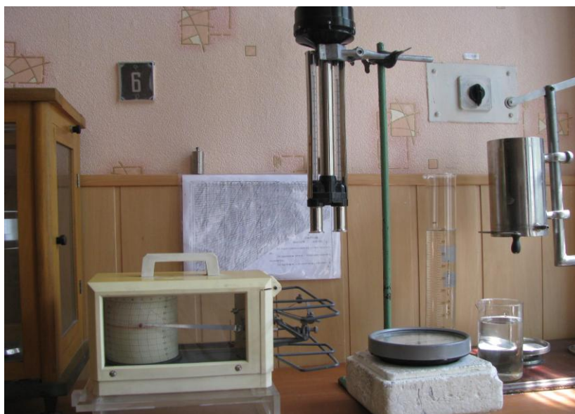
Рис. 1. Обладнання лабораторної роботи по визначенню вологості повітря.
