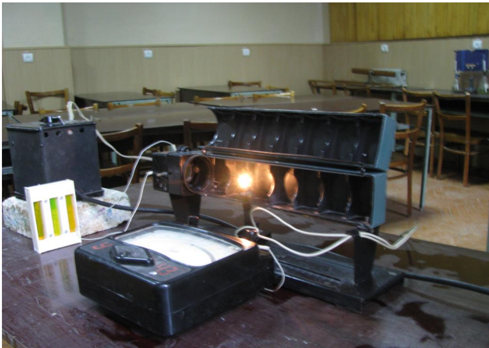
Рис. 1. Типова лабораторна робота по визначенню чутливості фотоелемента.
