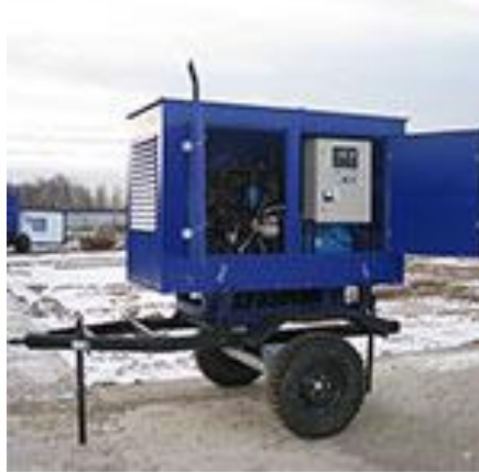
Рисунок 5.2 – Зовнішній вигляд пересувної насосної установки ПСМ ДНУ-215/140
