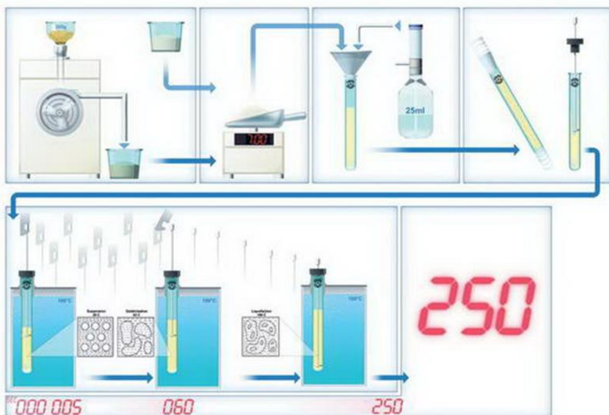
Рис. 21. Принцип роботи приладу FN1000
