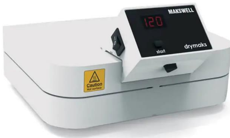
Рис. 26. Прилад для визначення вмісту сухої клейковини Drymaks
