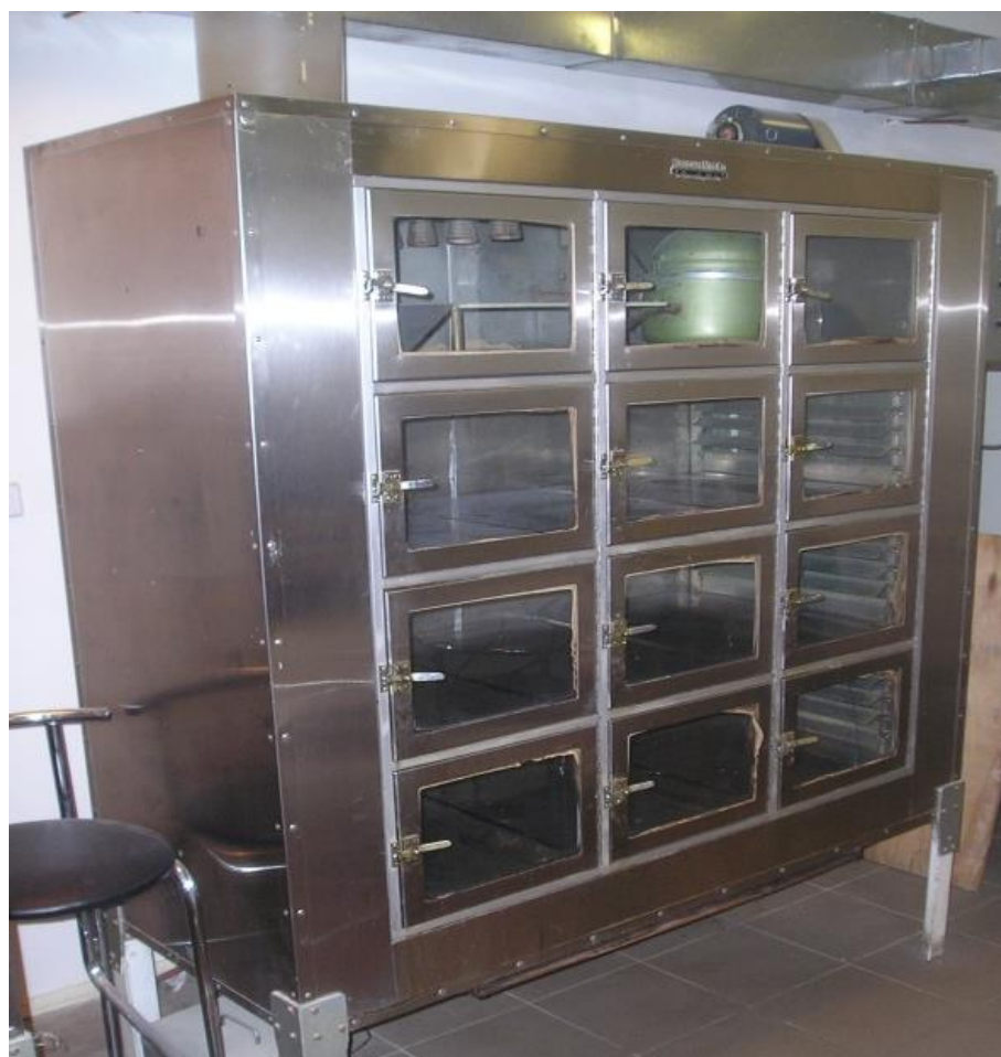
Рис. 37. Термостат для бродіння і розстойки тіста
