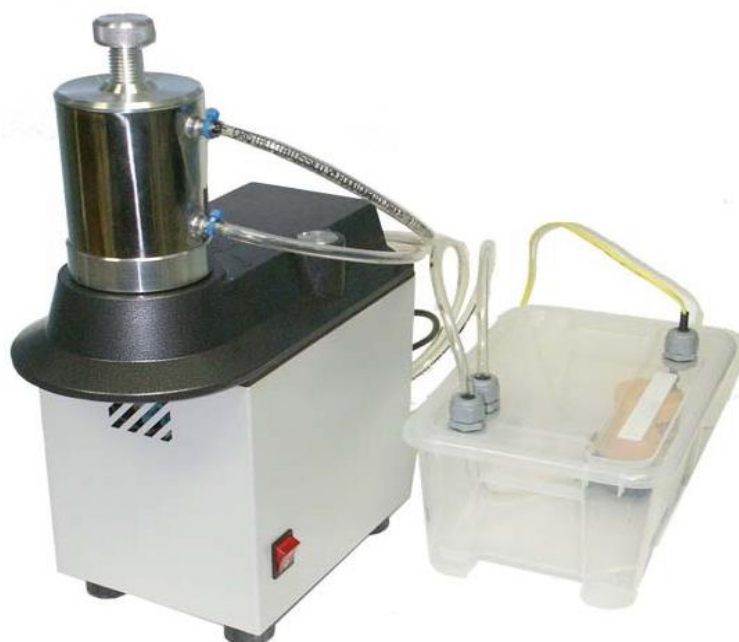
Рис. 23. Млин лабораторний автоматичний ЛМУ – 202 з охолодженням
