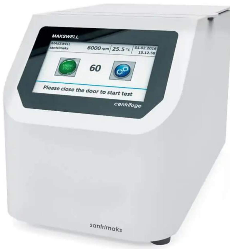
Рис. 25. Прилад для визначення індексу клейковини Santrimaks (центрифуга)
