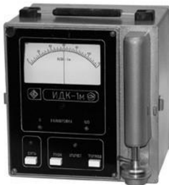
Рис. 27. Прилад для вимірювання індексу деформації клейковини «ВДК-1»
