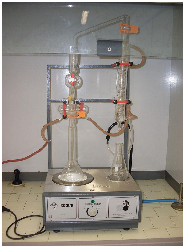
Рис. 44. Перегінний апарат Кьельдаля
