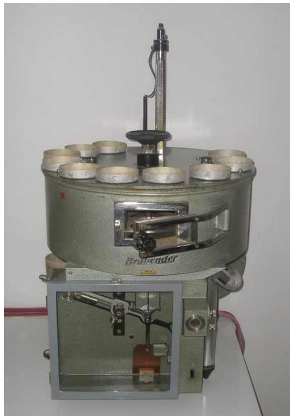
Рис. 17. Електрична напівавтоматична сушильна шафа Брабендера
