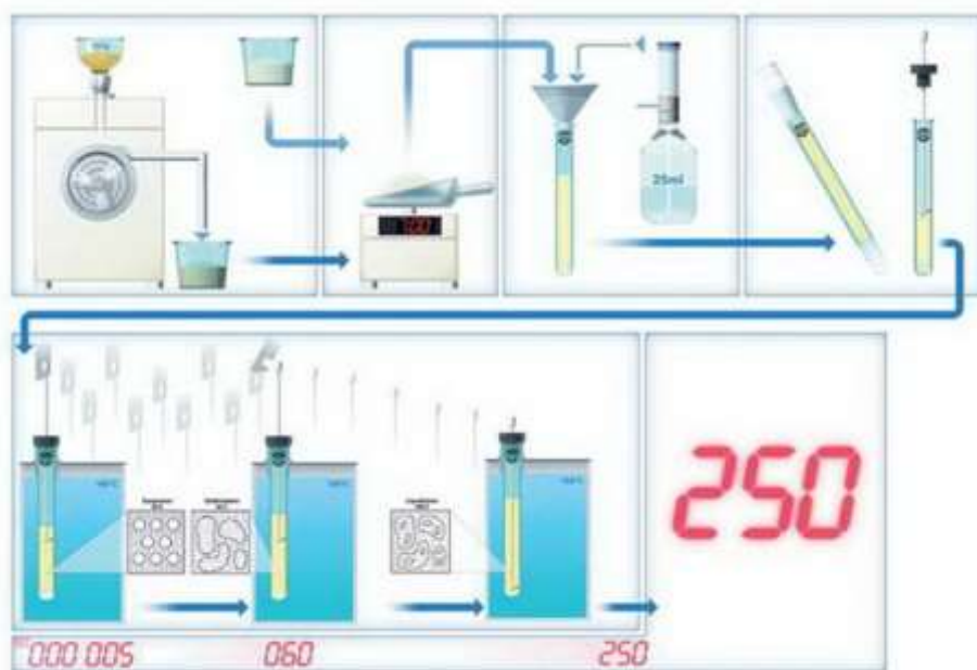
Рис. 21. Принцип роботи приладу FN1000
