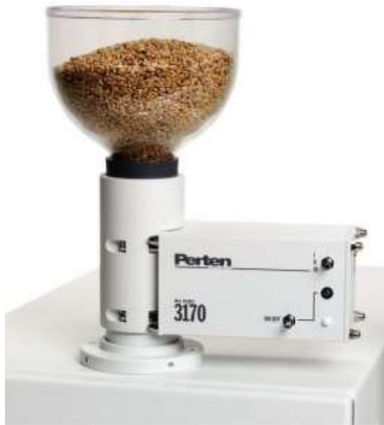
Рис. 19. Лабораторний молоткового типу млинок 3170 (фірма «Falling Number», Швеція)
