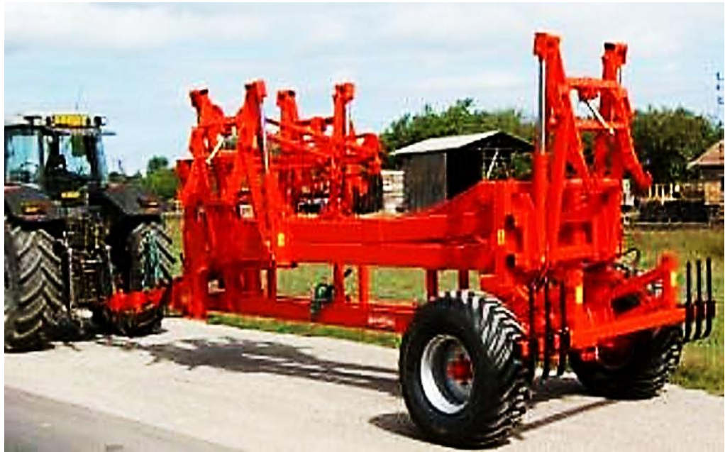
Рисунок 3.9 - Зчіпка сільськогосподарських знарядь ВРО
