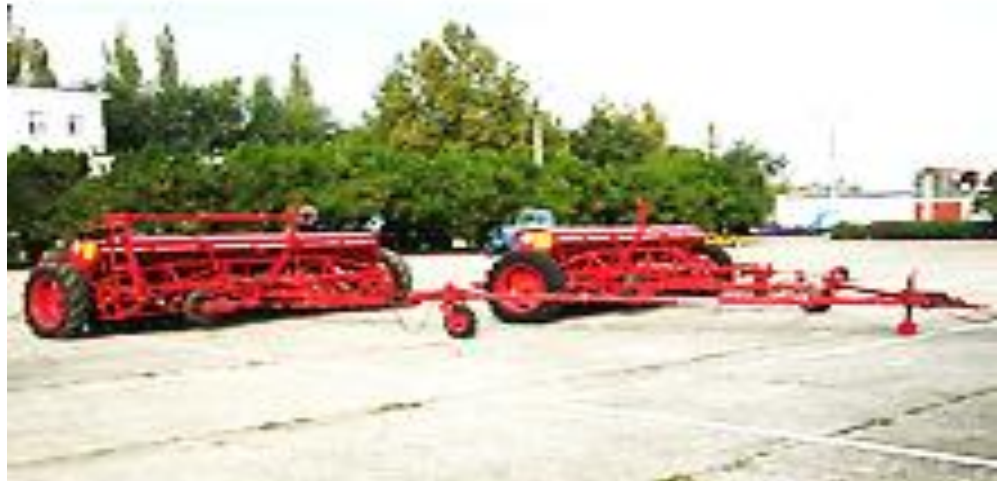
Рисунок 3.6 - Зчіпка СП-10,8-01 для агрегування зернових сівалок
