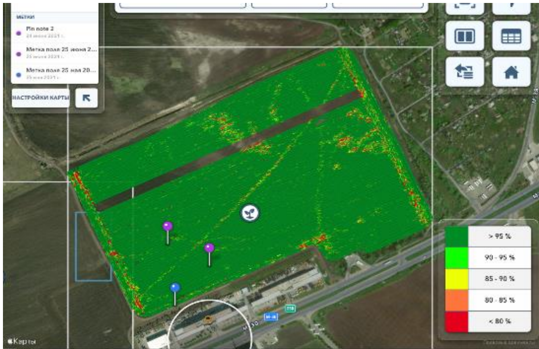
Рис.3.7. Характеристика зміни величини вібрацій від місця розташування посівного МТА на полі.
