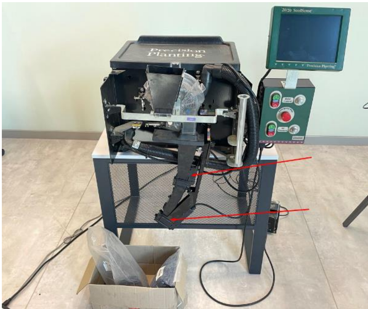
Рис. 2.4. Випробувальний стенд MeeterMax для досліджень ефективності якості сівби
