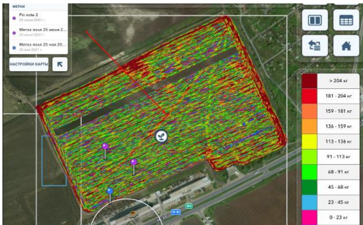
Рис.3.5. Результати отриманих зусиль в кожному окремому гідроциліндрі сівалки.
