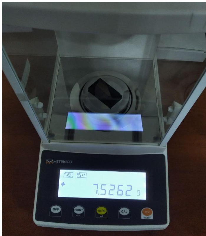
Рис. 3.4 – Визначення маси зразку з ПКМ УПА-6-30 на аналітичних терезах після випробування
