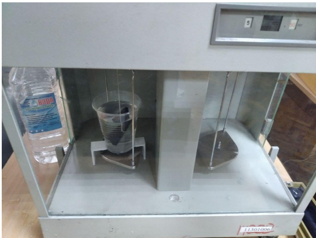
Рис. 3.3 – Зважування зразку з ПКМ на аналітичних терезах в середовищі дистильованої води
