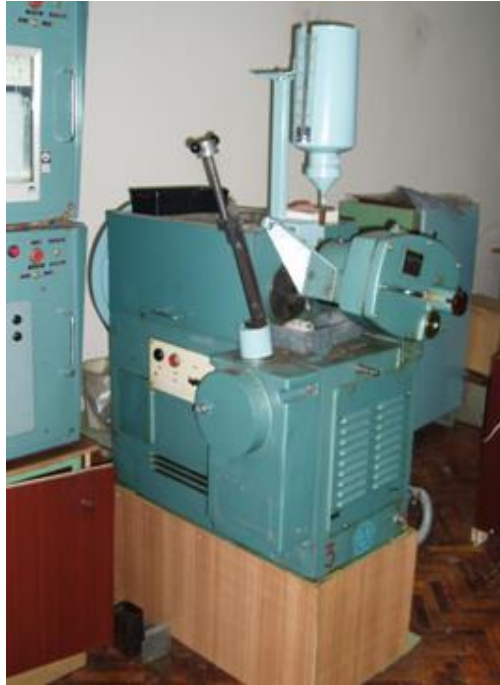
Рис. 2.7 – Машина СМЦ-2: а – з устаткування для подачі абразиву в зону тертя, б – схематичне зображення процесу абразивного зношування: 1 – ролик із гумовим ободком; 2 – електрокорунд (абразив); 3 – навантажувальний механізм; 4 – досліджуваний зразок
