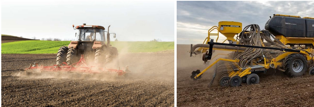
Рис. 1.1 – Наявність частинок ґрунту в робочій зоні МТА при виконанні обробітку ґрунту та сівби
