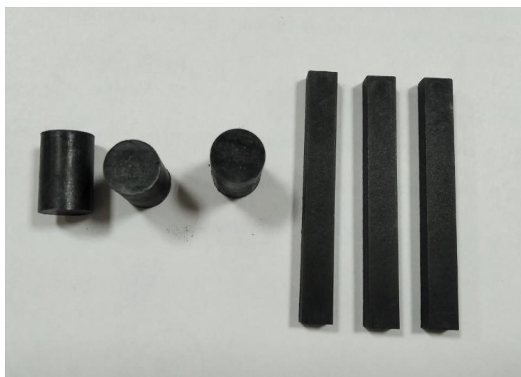
Рис. 2.5 – Експериментальні зразки для дослідження: а – фізико-механічних характеристик, б – абразивної зносостійкості
