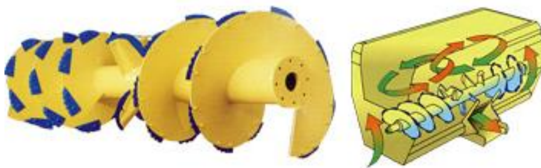
Рисунок 1.6 – Змішувальний ножовий шнек та схема переміщення корму в бункері змішувача-кормороздавача
