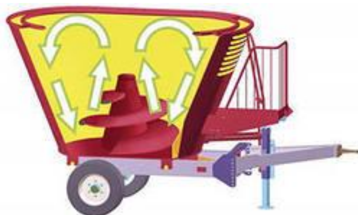
Рисунок 1.2 – Схема переміщення кормових компонентів в змішувачі-кормороздавачі з вертикальним шнеком
