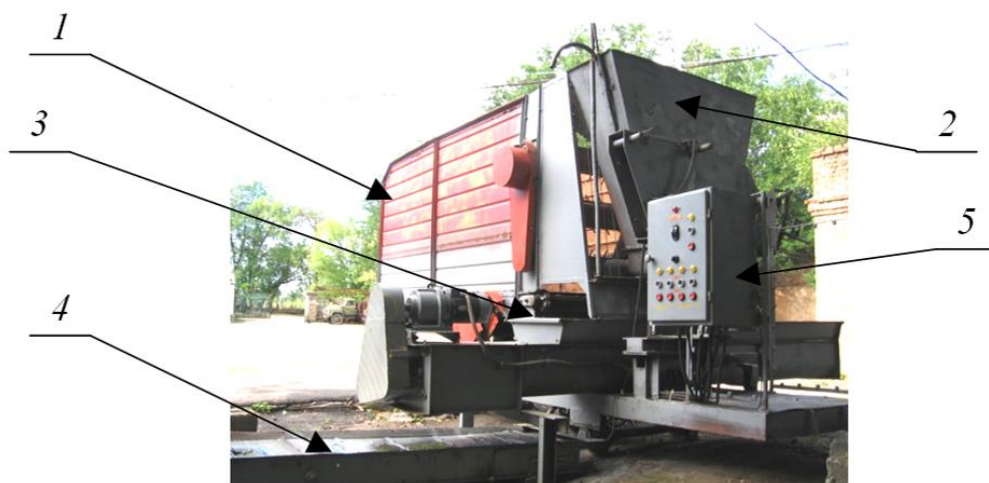
Рисунок 3.1 – Експериментальний зразок змішувача-кормороздавача потокового типу: 1 – бункер-дозатор стеблових кормів; 2 – бункер-дозатор концентрованих кормів; 3 – лопатевий змішувач; 4 – стрічковий транспортер; 5 – пульт керування електрообладнанням
