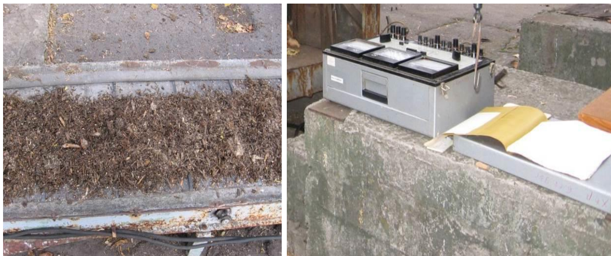
Рисунок 3.3 – а – кормосуміш для відбору проб; б – контрольно-вимірвальний пристрій К – 506 з журналом реєстрації даних
