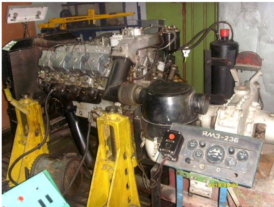
Рисунок 3.2. – Загальний вигляд стенда для випробувань ДВЗ
