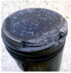
Тріщина в перемичці поршня
