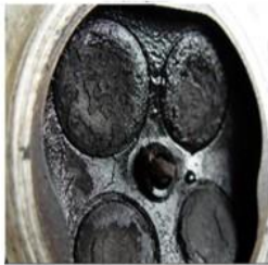
Підвищення нагару в камері згорання та підвищений знос маслозємних ковпачків
