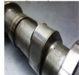
Дефект профілю кулачка розподільчатого валу
