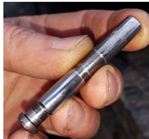
Абразивний знос робочої поверхні та сліди захоплення
