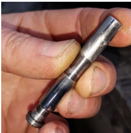
Абразивний знос робочої поверхні та сліди захоплення
