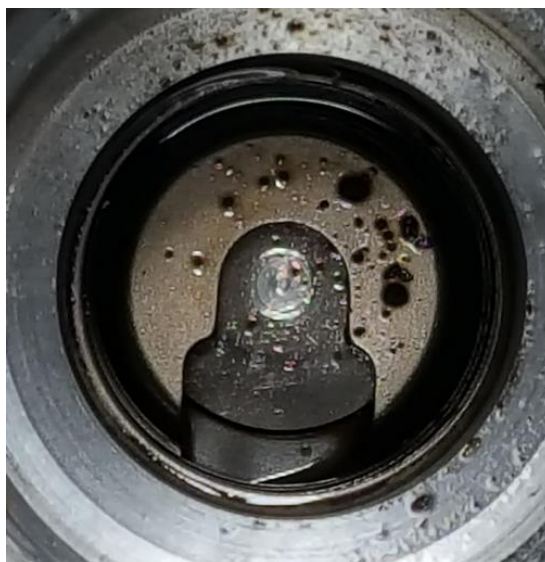
Бруд, та вода в колодязі плунжерної пари
