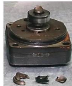
Руйнування плунжера ПНВТ
