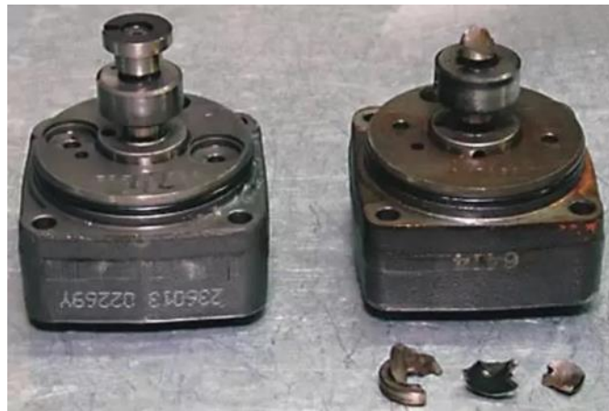
Руйнування плунжера ПНВТ
