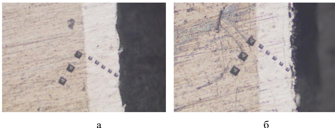
Рис.1. Металографічні шліфи зразків з покриттями на основі хрому після вимірювання мікротвердості (x100):
