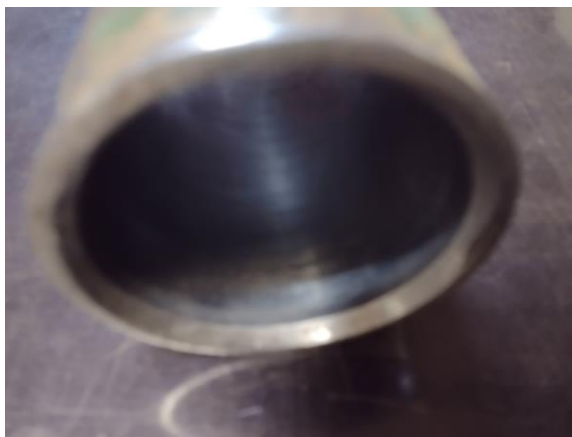
Рис. 4.1 – Зовнішній вид зношення внутрішньої поверхні корпусу
