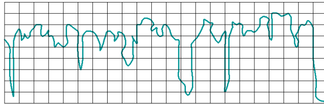
Рис. 4.13 – Фрагмент профілограми поверхні штока, відновленого плазмовим наплавленням і обробленого шліфуванням і ППД (варіант 1.2)
