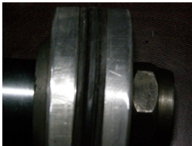
Рис. 4.3 – Зовнішній вид зношення поршня
