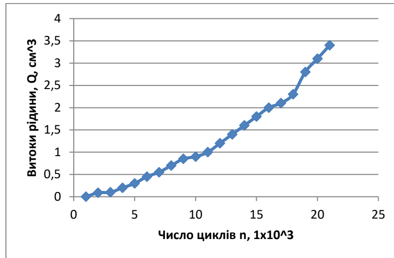
Рис. 4.14 – Витоки рідини (Q) залежно від числа циклів (n) при відновленні штоків плазмовим наплавленням з наступним шліфуванням і нанесенням полімерного покриття, гумове кільце з покриттям ФБФ-74Д (варіант 1.3)
