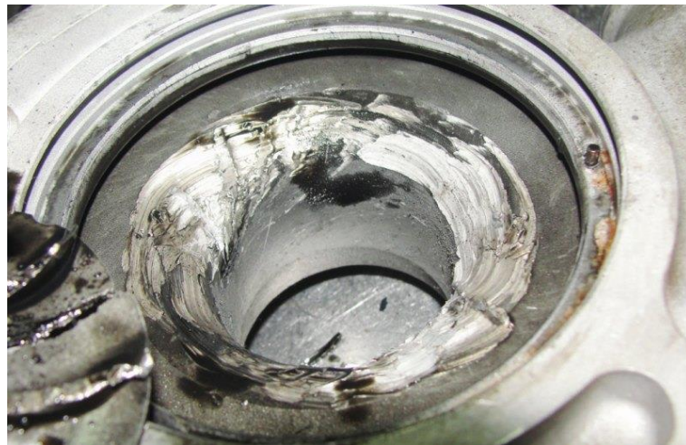
Рис. 3.6. Подряпини від крильчатки турбіни на равлику
