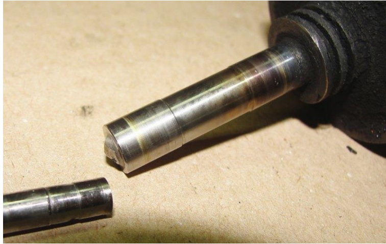
Рис. 3.7. Руйнування валу крильчатки внаслідок втоми
