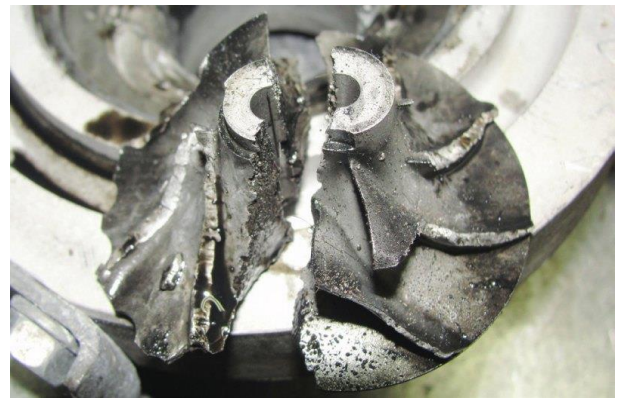
Рис. 3.5. Дефекти лопатей крильчатки внаслідок потрапляння стороннього предмету чи перегріву
