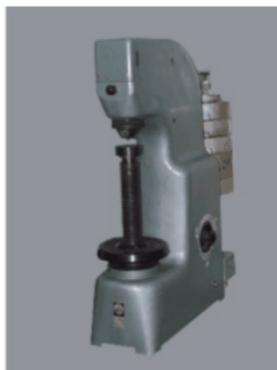
Рис. 3.17. Схема приладу для виміру твердості матеріалів ТШ-2М по методу Бринелля
