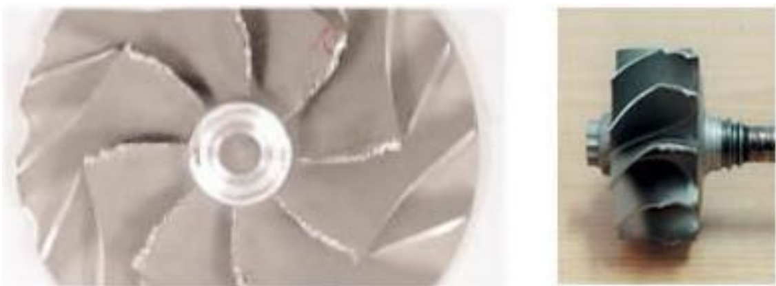
Рис. 1.3. Пошкодження, внаслідок потрапляння сторонніх предметів
