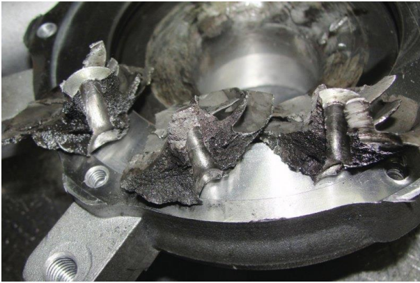
Рис. 3.5. Дефекти лопатей крильчатки внаслідок потрапляння стороннього предмету чи перегріву
