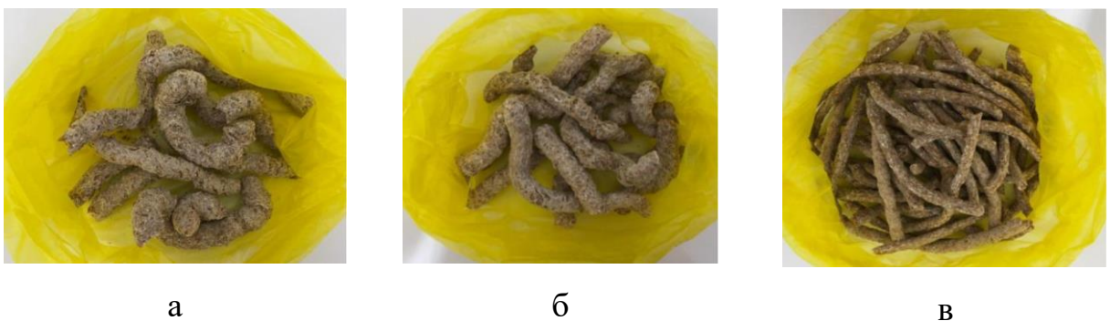
Рисунок 1.3 – Екструдат зерна пшениці: а – при вологості 18%; б – при вологості 22%; в – при вологості 26%
