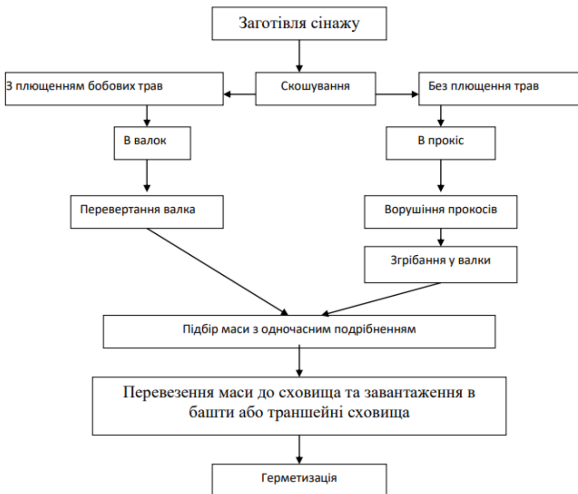
Рисунок 1.4 – Технологічна схема заготівлі сінажу
