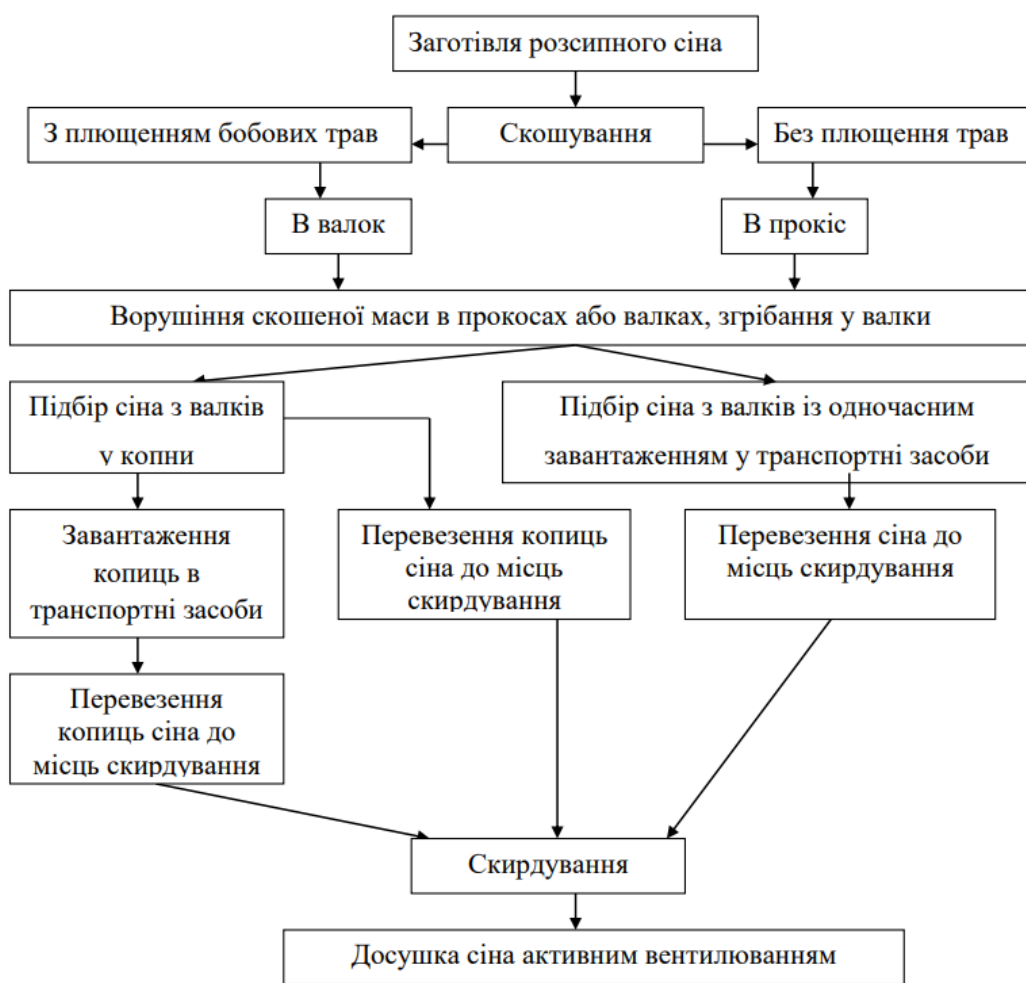
Рисунок 1.1 – Технологічна схема заготівлі розсипного сіна
