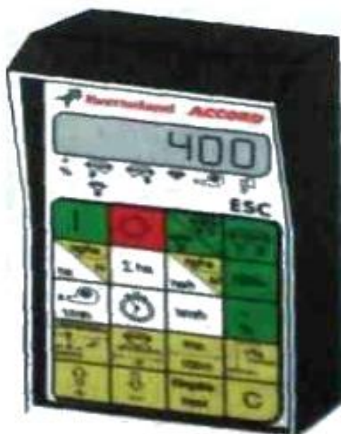
Рисунок 1.8 – Монітор електронної системи керування і контролю роботи сівалок «Miller Electronic»
