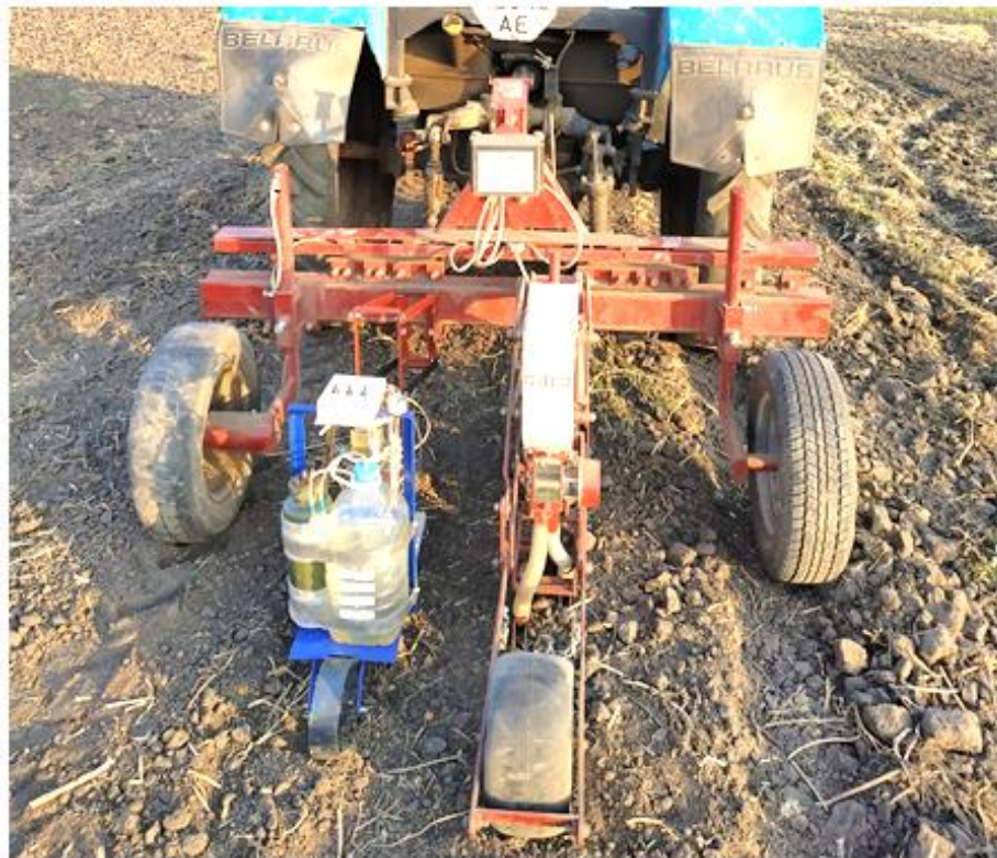
Рисунок 3.13 – Посів томату «Солеросо» експериментальною гідросівалкою та посівною секцією сівалки Клен
