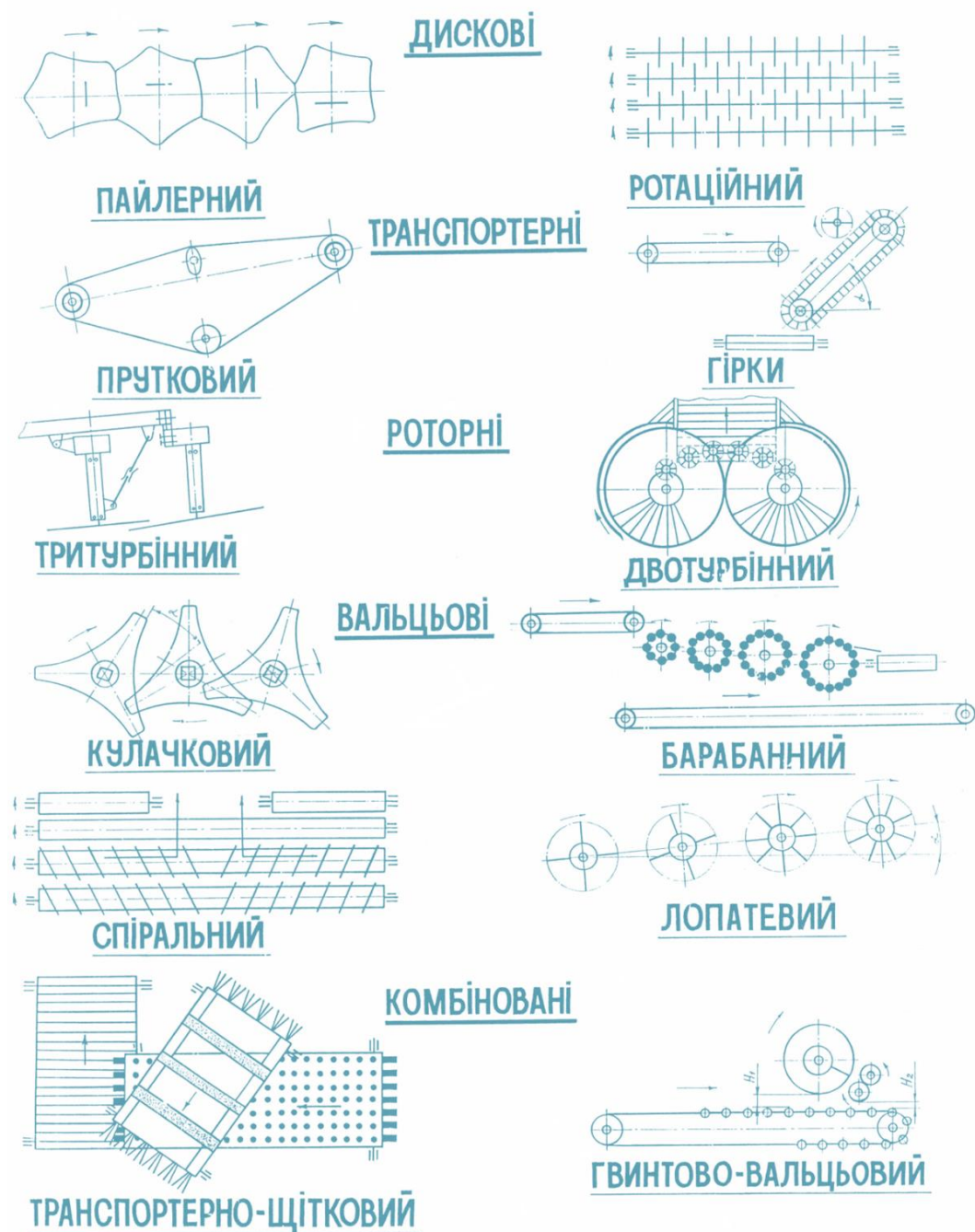
Рис. 1.1. Конструктивні схеми очисників вороху коренеплодів.
