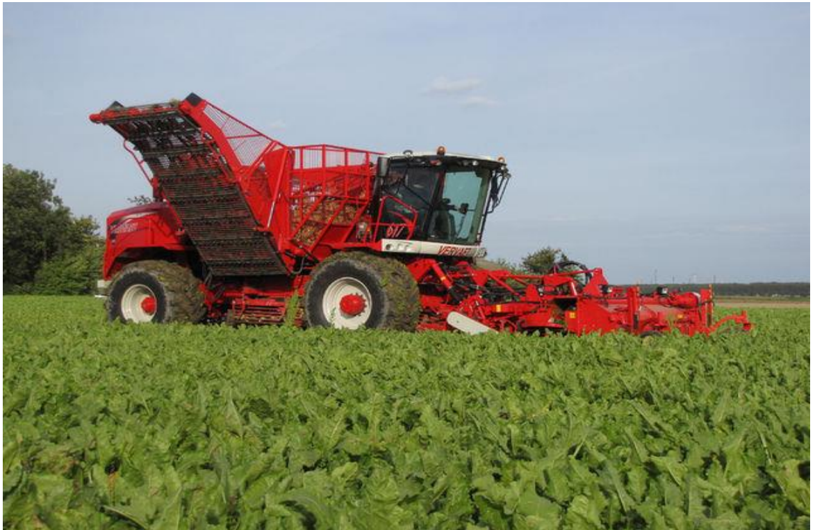
Рисунок 2.3 - Комбайн бурякозбиральний самохідний бункерний VERVAET – 617
