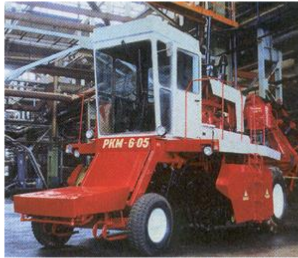
Рисунок 2.11 - Самохідна коренезбиральна машина РКМ-6
