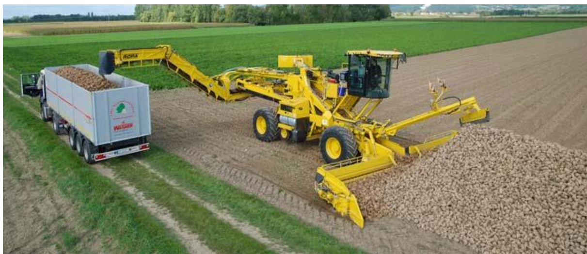
Рисунок 2.10 - Навантажувач коренеплодів фірми ROPA
