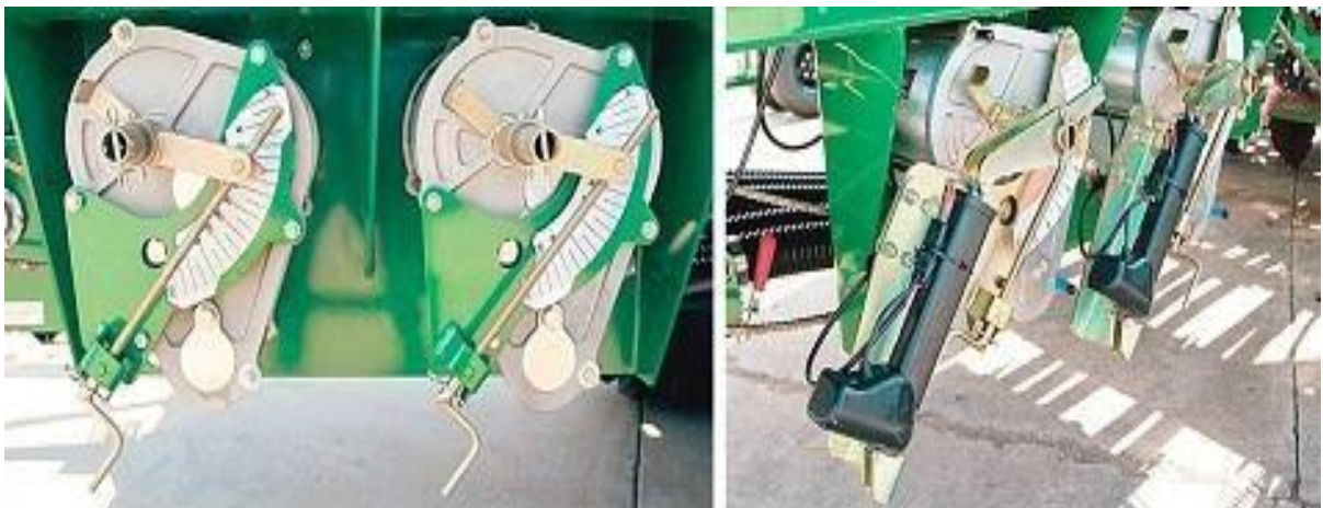
Рисунок 1.9. Регулювання норми висіву: звичайне (а); автоматичне (б), гідроприводом Ag Leader Technology & Brunswick CVA.
