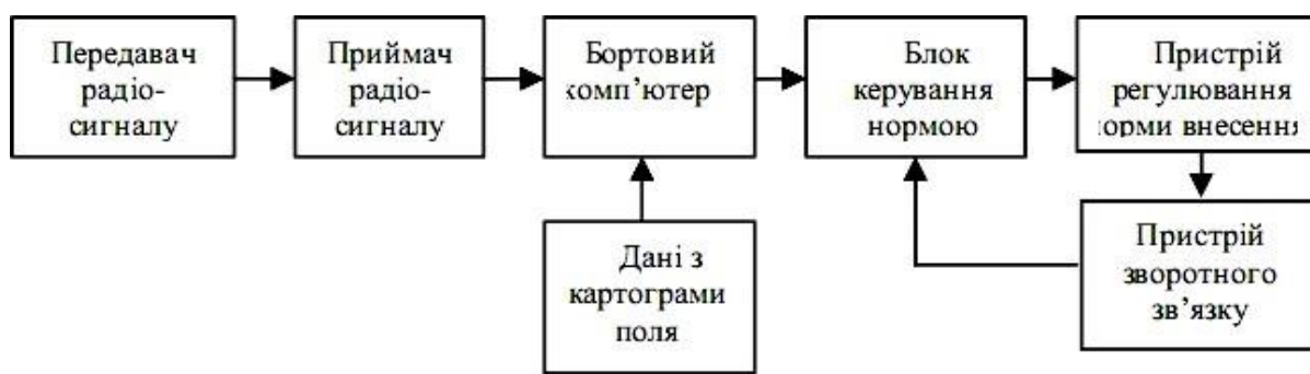
Рисунок 1.7. Схема роботи системи управління нормою висіву.
