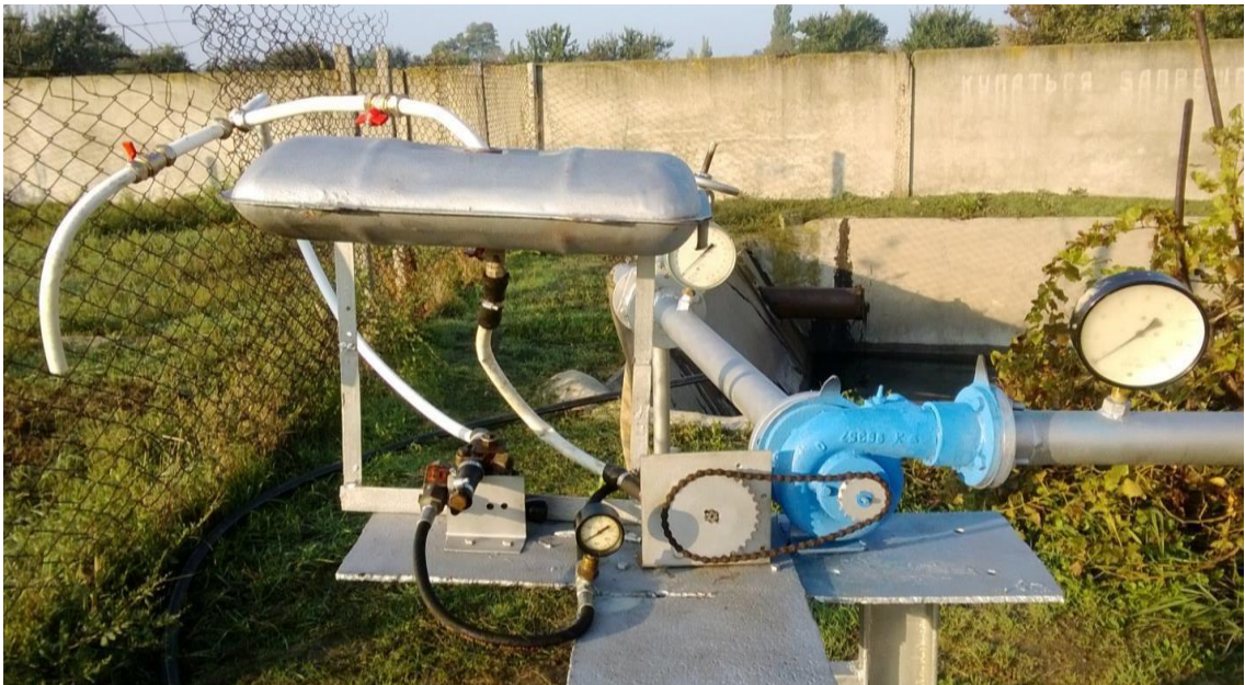
Рис. 4.1 Загальний вигляд макетного зразка гідротурбінного привода з гідравлічним насосом.
