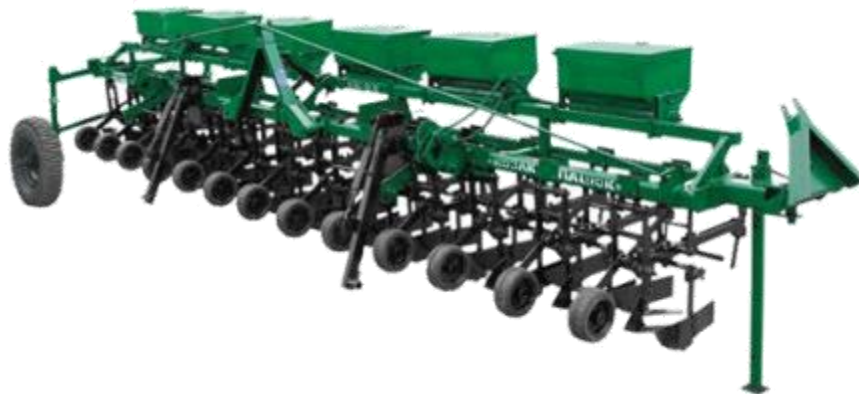
Рис. 2.3. Культиватор просапний КП-5, 6 «Казак «Пацюк»
