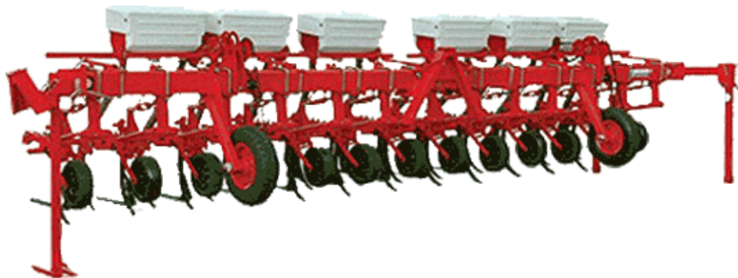
Рисунок 2.4 - Культиватор-рослинопідживлювач навісний високостебельний КРНВ-5,6-02
