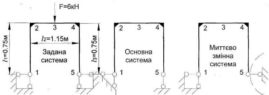
Рисунок 6.1. Розрахункова схема рами транспортного пристрою культиватора
