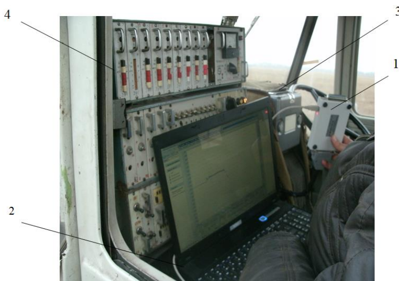
Рисунок 3.2. Інформаційно-вимірювальна система тензотрактора Т-150К:
