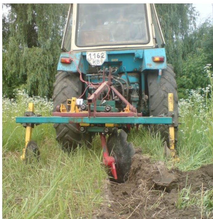
Рисунок 4.3. Тензометрична установка з сферично-дисківим робочим
