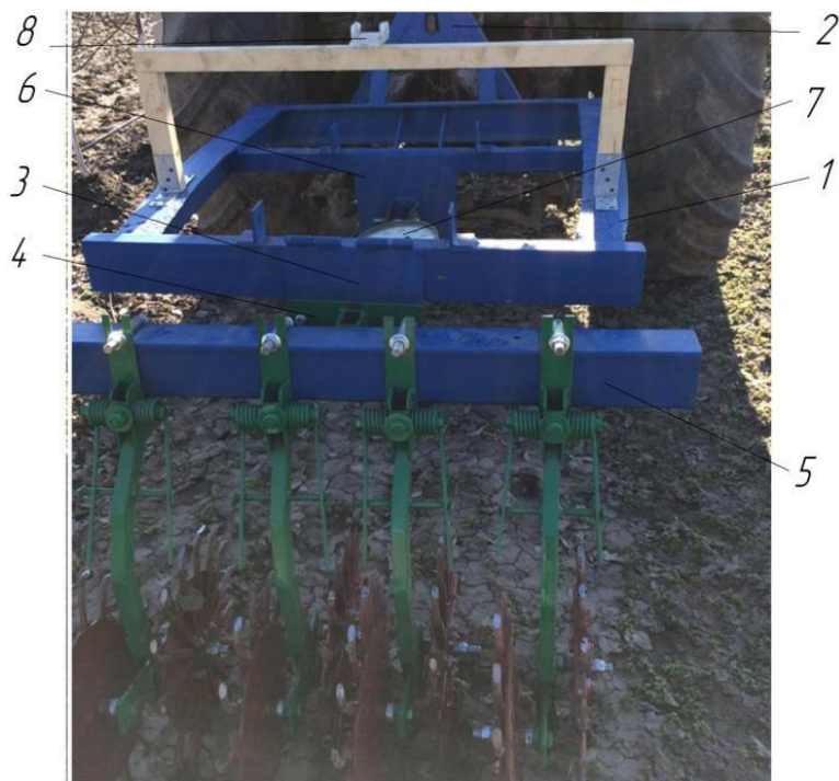
Рисунок 3.5 - Експериментальна установка для визначення енергетичних показників секції ротаційної мотиги
