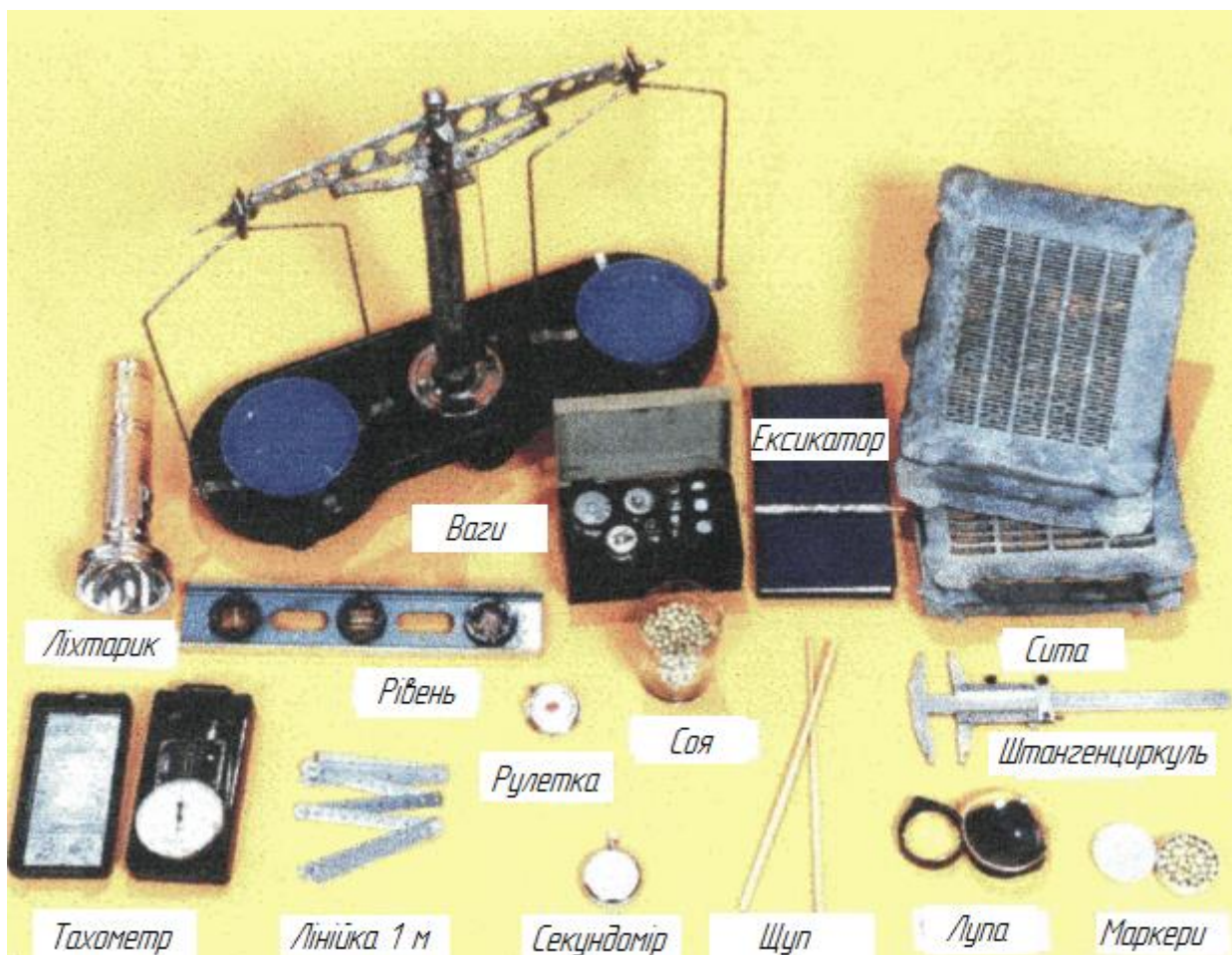
Рисунок 3.8 – Прилади та інструменти, що були використані при проведенні експериментальних досліджень
