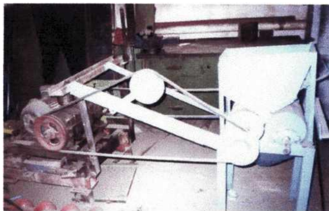
Рисунок 2.1 – Вид експериментального обладнання для луцення насіння сої методом зрушення сім'ядоль.
