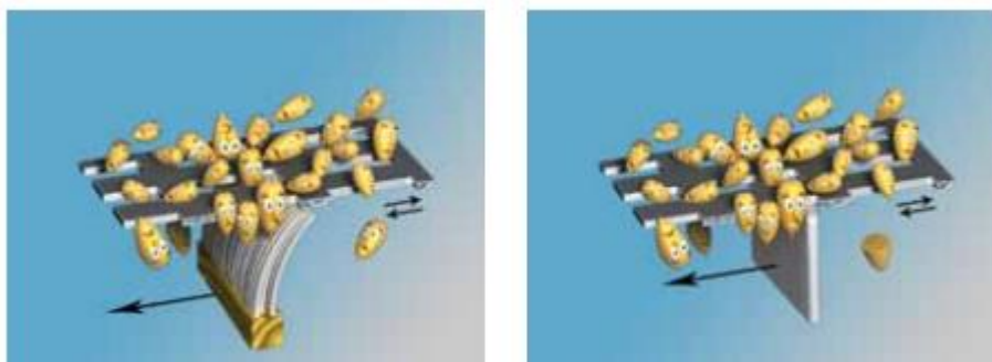
Рисунок 3.3- Травмування зерна на решітках зі сталевго тонкого листа при щіткового (ліворуч) та Рисунок 3.4-скребкового (праворуч) очищення
