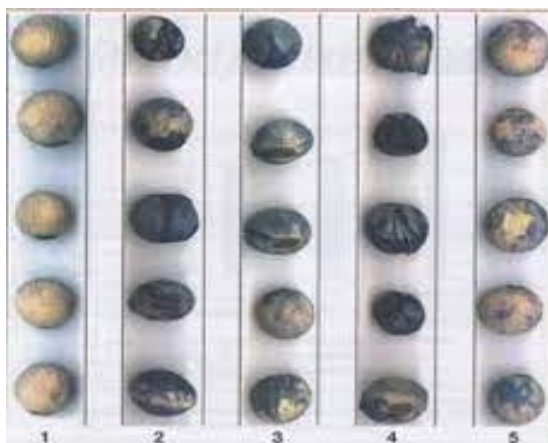
Рис 2.2 Травмування насіння сої (забарвлення розчином індигокарміну): 1 – ціле насіння, 2 – макротравми насіннєвої оболонки, 3 - мікротравми насіннєвої оболонки, 4 - макротравми сім'ядолів, 5 - мікротравми сім'ядолів
