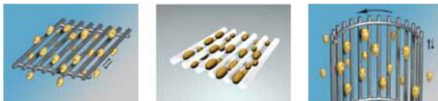
Рисунок 3.5- Принцип взаємодії зерна та решета нової геометрії
