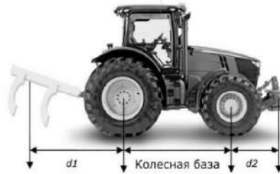
Рис.1 – Перерозподіл експлуатаційної ваги трактора з навісним зняряддям
