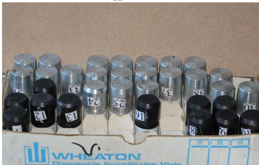
Рисунок 3.2 - Десорбція радону з вугільної пастки
