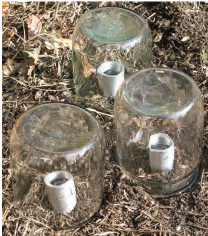
Рисунок 3.1 - Схема відбору проб радону з повітря, що надходить з ґрунту в пастку
