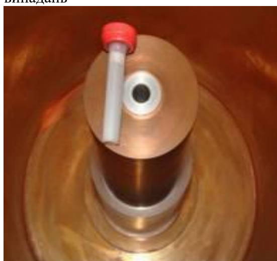
г) детектор надчистого германію (HPGe) серії GWL, холдер із пробєю
