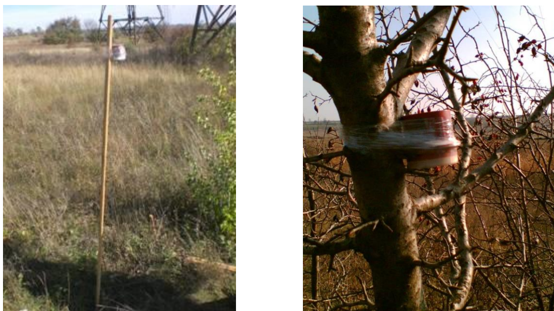
Рисунок 4.8 - Розміщення трекових детекторів на місцевості для визначення ОА радону-222 в повітрі
