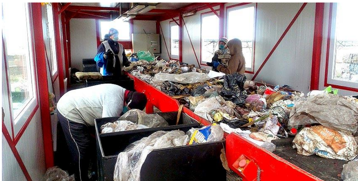
Рисунок 1.7 – Сміттесортувальна лінія на заводі.
