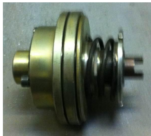
Рис. 2. Загальний вигляд пружно-запобіжної муфти з плавним пуском
