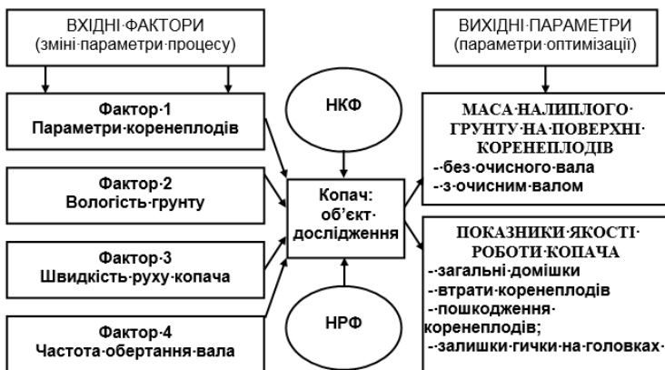
Рис. 1. Загальна схема структурної моделі комбінованого копача
