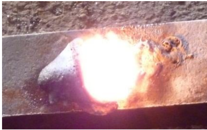
Рис. 1. СВС-процес формування композиційного матеріалу 70% (Ti+C+Fe 2 O 3 +Al) + 20% ПГ-10Н-01 + 10% ПТ-НА-01
