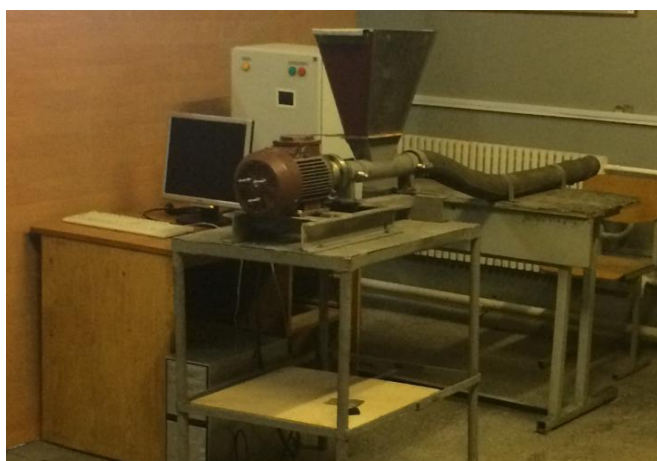
Рис. 3. Загальний вигляд експериментальної установки для дослідження привода гвинтового конвеєра
