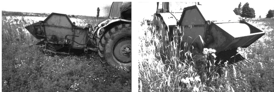
Рис. 3 Польові випробування макетного зразка двохбарабанної обчісуючої жатки
