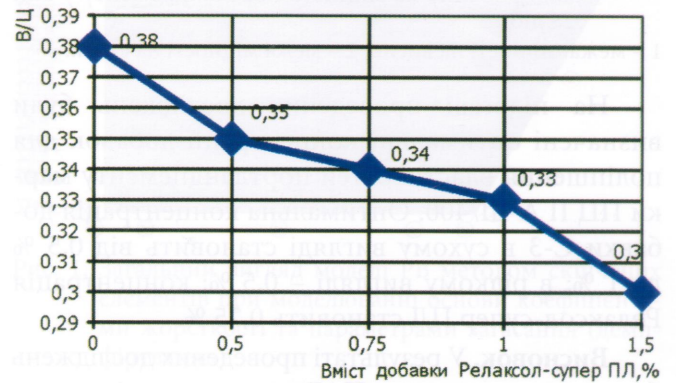
Рис. 14. Вплив вмісту добавки Релаксол-супер ПЛ на В/Ц портландцементу.
