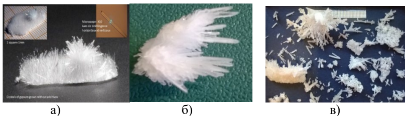
Рис.3. Фотографії кристалів \text{CaSO}_4 \cdot 2\text{H}_2\text{O} вирощуваних методом зустрічної дифузії: а) – без добавок; б) – з пластифікатором Sika Visco Grete; в) – Sika Visco Grete і нанопорошок «Тауріт»
