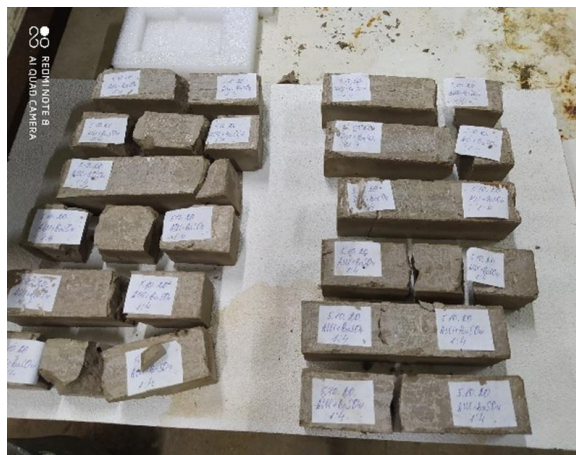
Рис. 7. Фото зразків рентген захисного складу, – а); криві ДТА – б)
