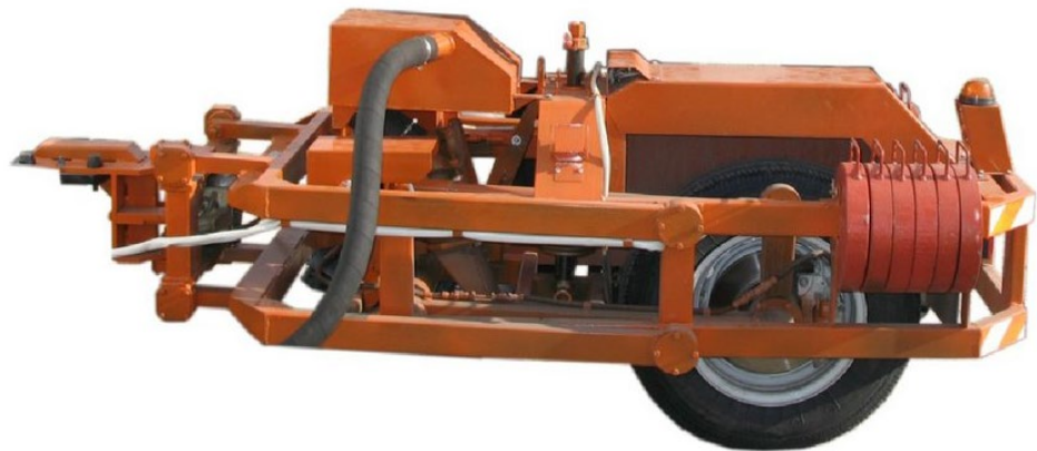
Малюнок 1.10 – Установка ПКРС-2 для вимірювання коефіцієнта зчеплення [17]:
