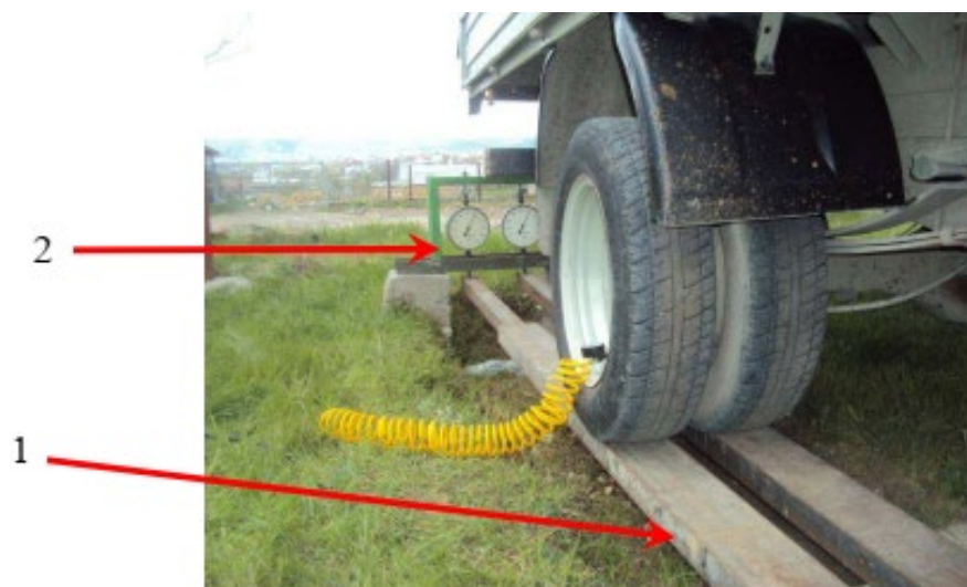
Рисунок 3.3 – Встановлення опорних коліс автомобіля на клавішний стенд [23]:
