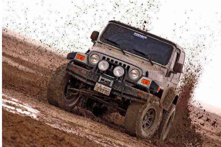
Рисунок 1.12 – Виникнення повного буксування коліс
