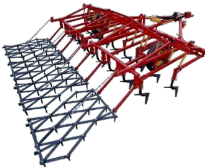
Рис. 1.3 – Культиватор КПС-4 з боронами
