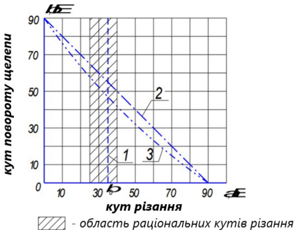
Рисунок 3.3 - Взаємозв'язок кута повороту щелепи ковша з кутом різання:
