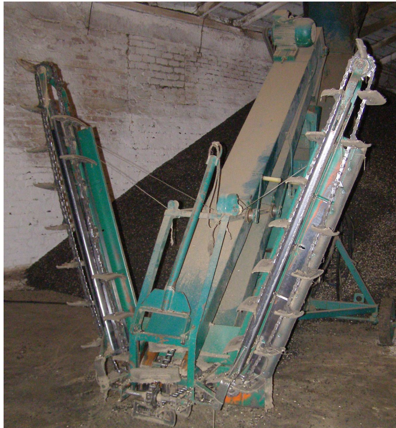
Рисунок 3.5 – Скребковий зерноавантажувач тиру ПЗС-160
