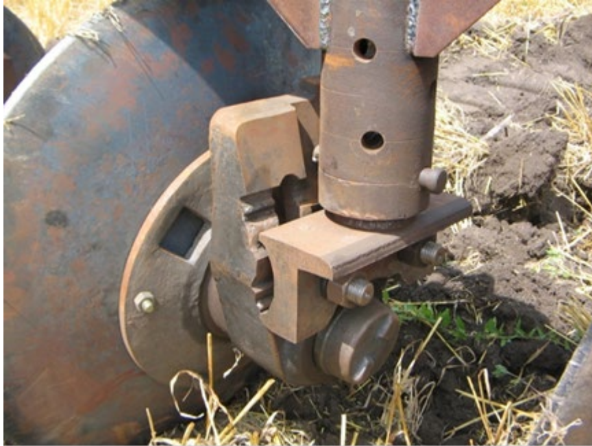
Рисунок 1.3 – Механізм регулювання кутів постановки диска: 1 - диск; 2 - стійка; 3 - кронштейн; 4 - маточина; 5 – отвори зміни кута атаки до напрямку руху агрегату; 6 – устрій зміни кута атаки до вертикалі.
