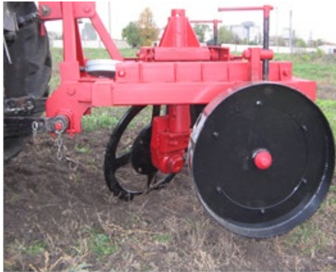
Рис. 3.8 - Загальний вид візка для визначення складових тягового опору
