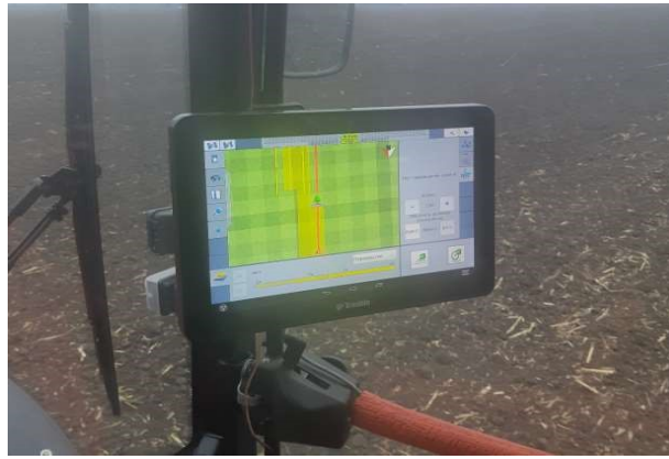
Рисунок 3.11 – Відхилення осі секції культиватора від заданої траєкторії навігаційної системи
