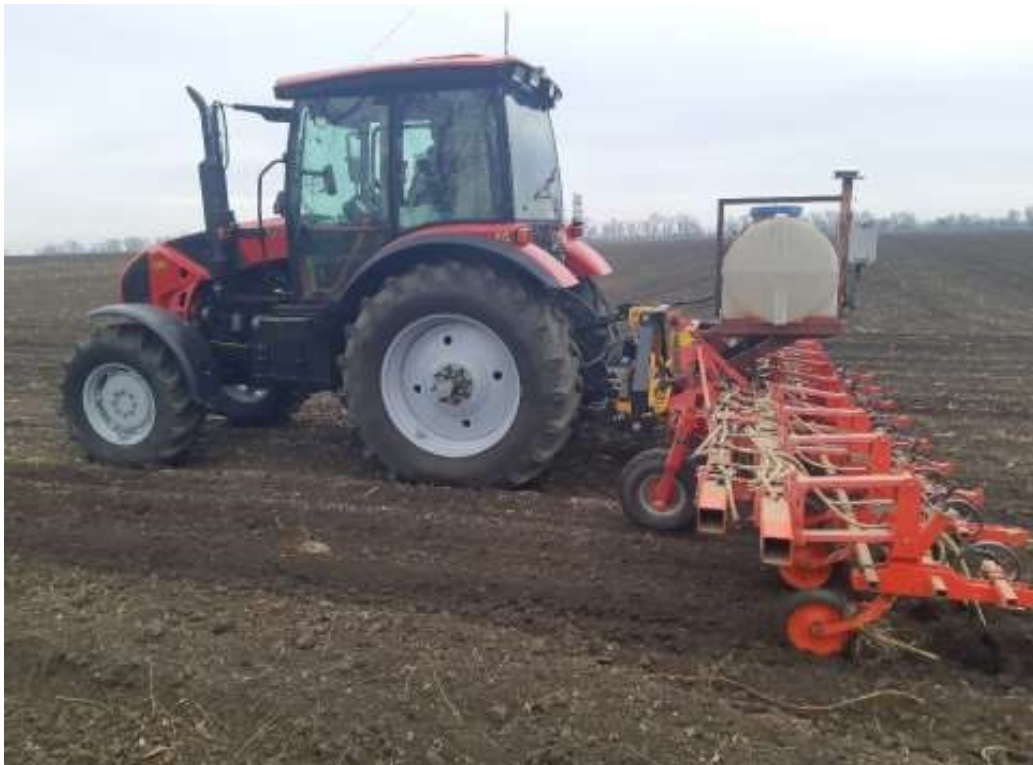
Рисунок 3.1 – Керований удосконалений навісний механізм УНМ-3 з культиватором Kasmos HL-8 в агрегаті з трактором МТЗ-1523
