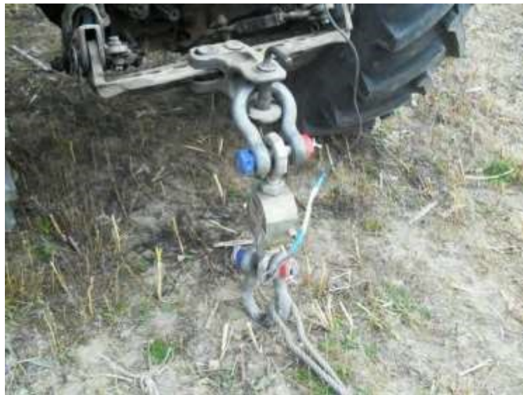
Рисунок 3.9 – Визначення тягових навантажень за допомогою електронного динамометра ЕВК-10Р
