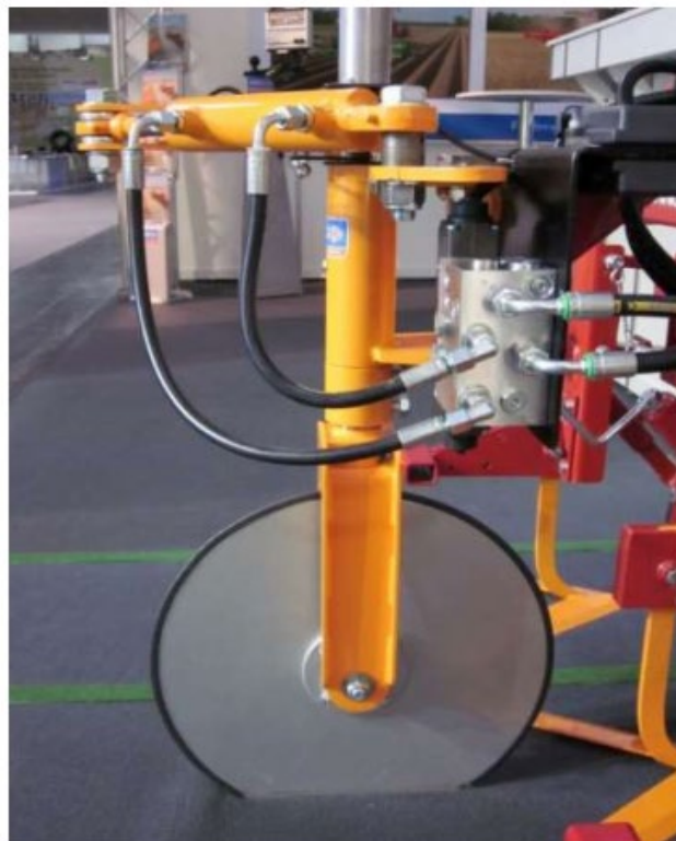
Рисунок 1.8 – Механізм коригування напрямку руху зняряддя компанії SBG
