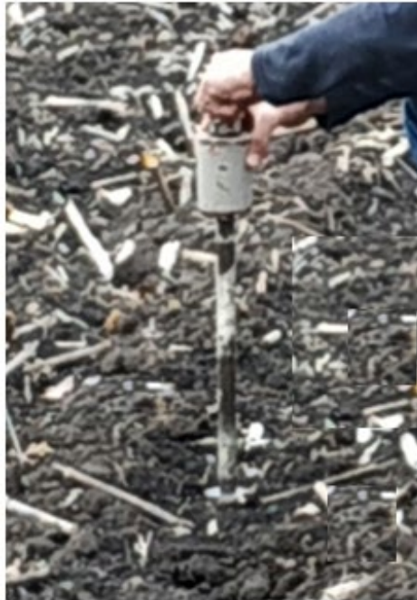
Рисунок 3.7 – Польові дослідження питомого зчеплення часток ґрунту
