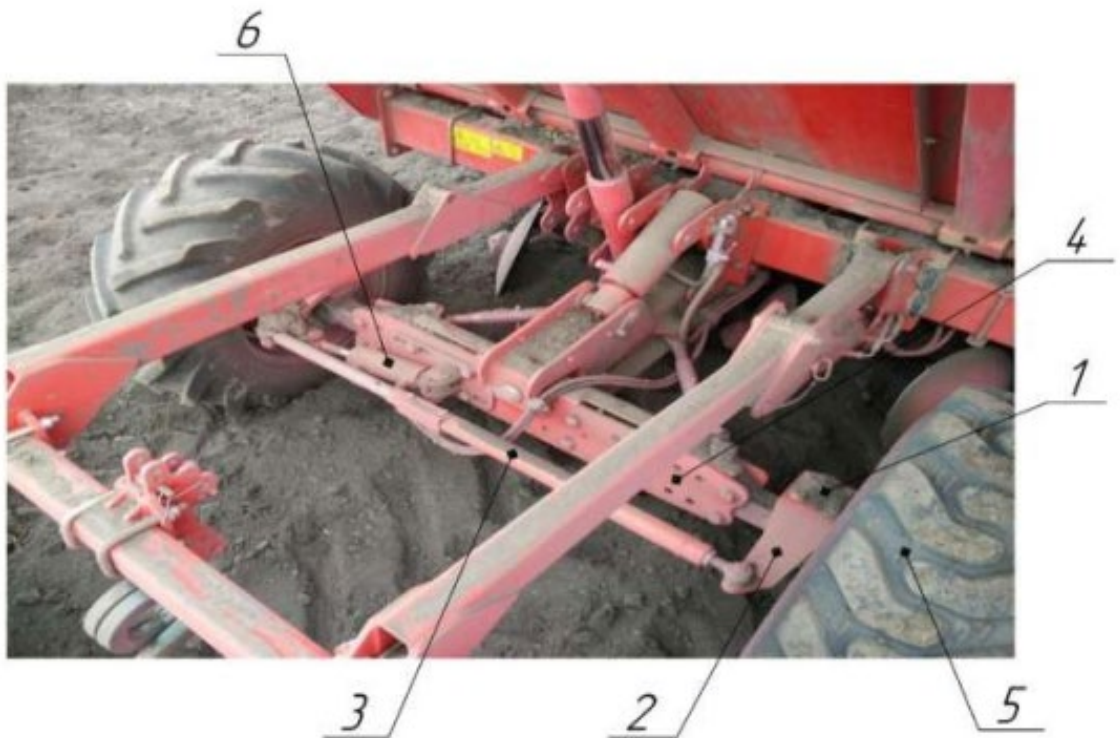
Рисунок 1.9 – Підрулюючий механізм картоплесаджалки Grimme: 1 – поворотний кулак; 2 – поворотний важіль; 3 – поперечна тяга; 4 – вісь; 5 – колесо
