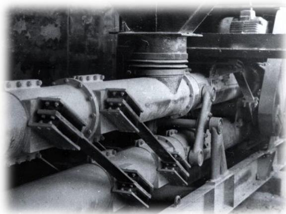
Рисунок 6 – Вибрационные конвейеры типа KB2T-03 с герметизаторами Г-200
