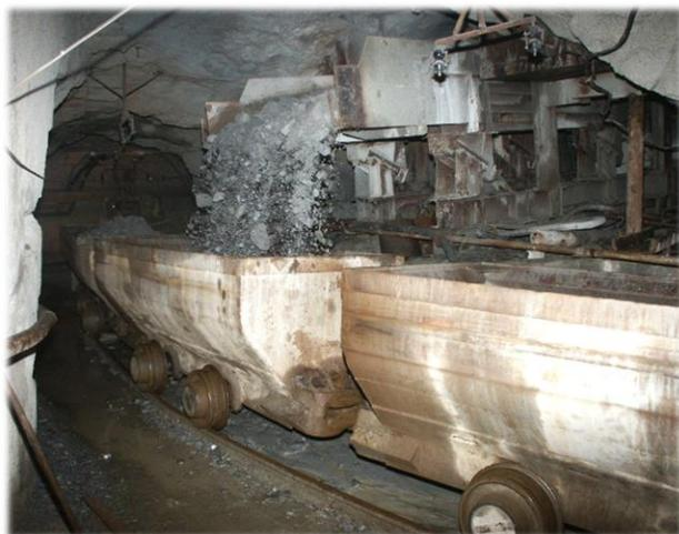
Рисунок 3 – Вибропитатель для выпуска руды из блока
