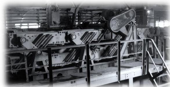
Рисунок 7 – Вибрационный конвейер-грохот типа КГВ-1,1/10,5
