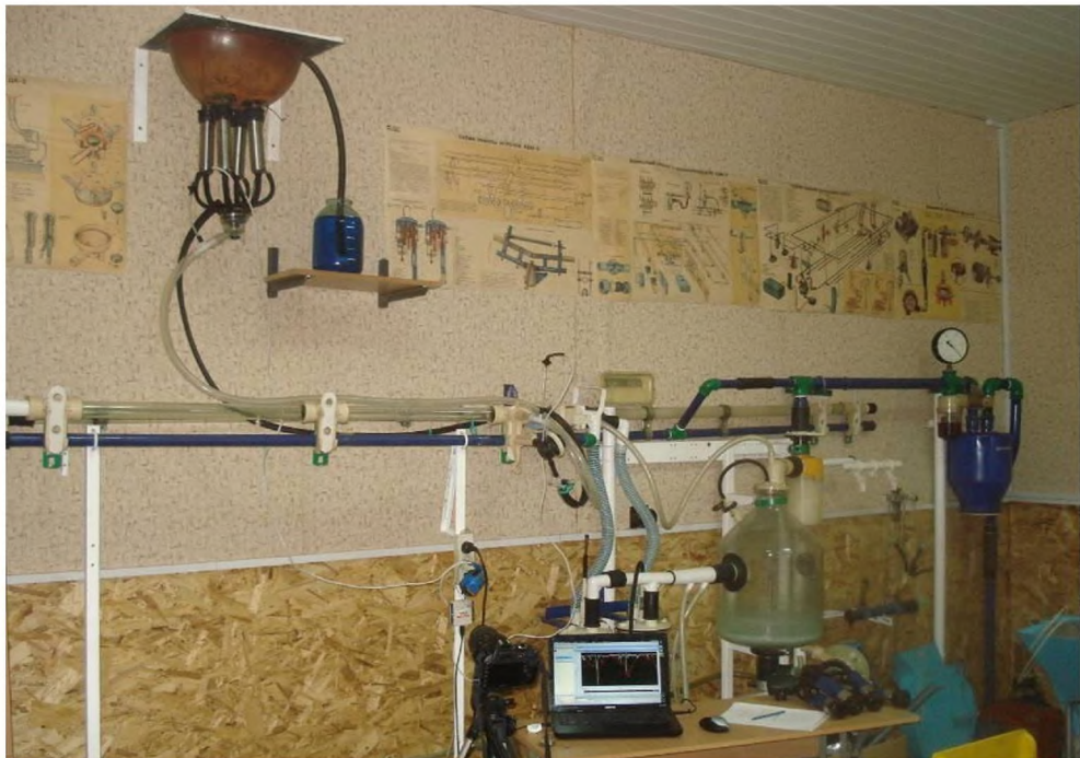
Рисунок 3.3 – Загальний вид експериментального стану доїльної установки із доїльним апаратом одночасної дії при підключенні його до нижнього молокопроводу
