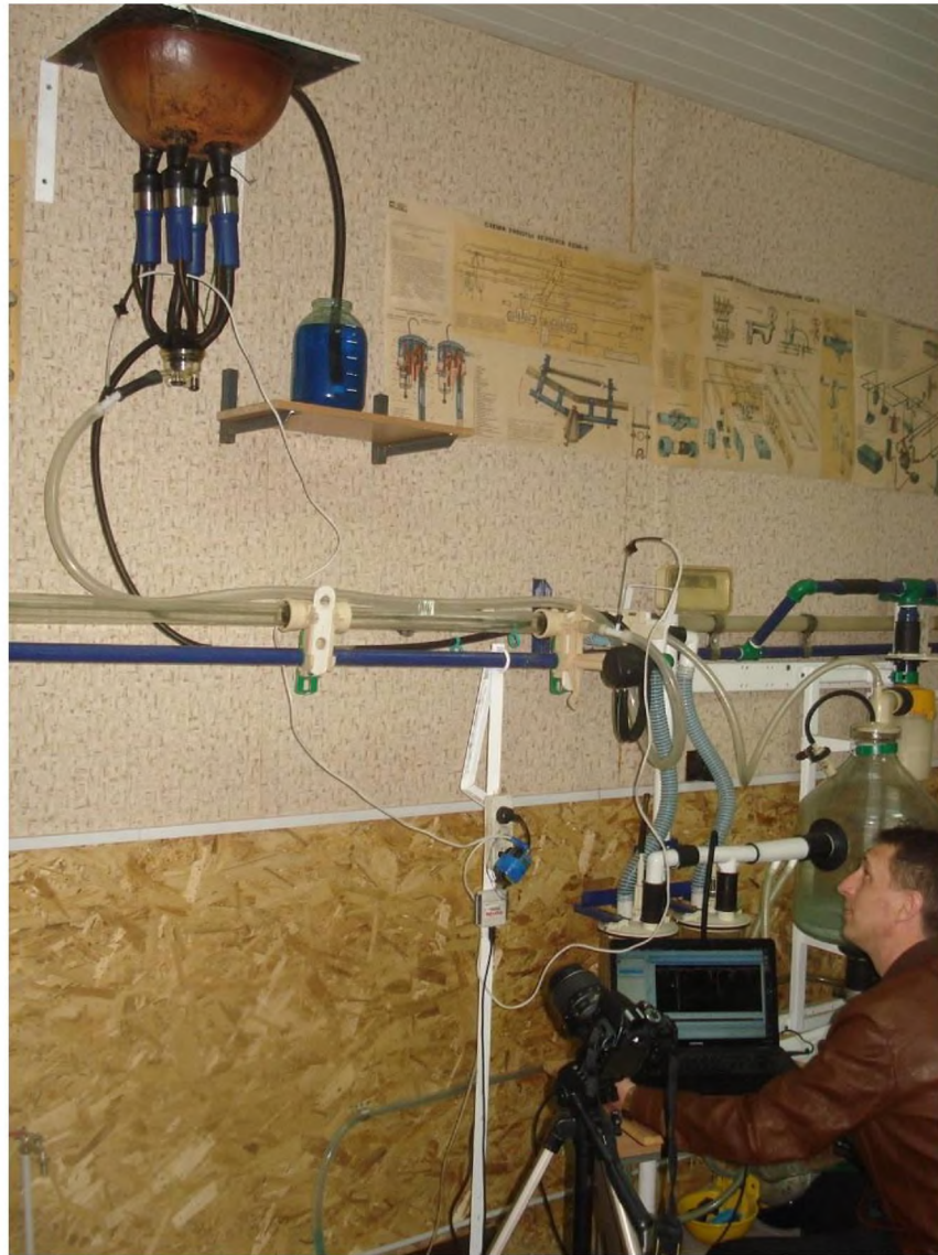
Рисунок 3.4 – Загальний вид експериментального стенду доїльної установки із доїльним апаратом попарної дії при підключенні його до нижнього молокопроводу
