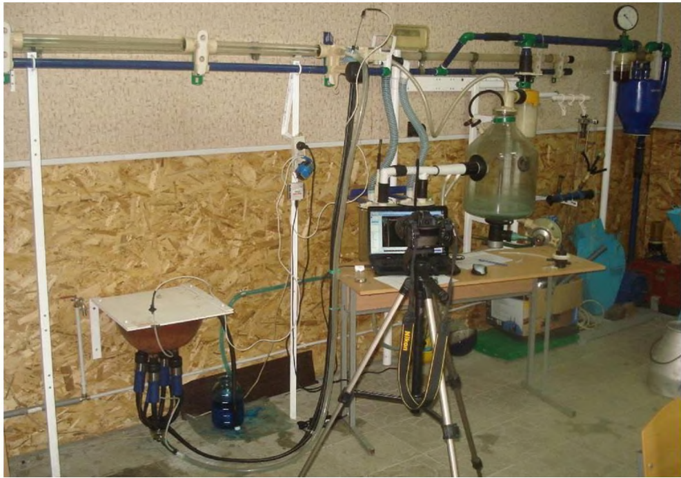
Рисунок 3.2 – Загальний вид експериментального стану доїльної установки із доїльним апаратом попарної дії при підключенні його до верхнього молокопроводу
