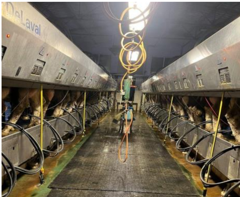
Рис. 18. Доїльна зала «Паралель» на 40 місць
