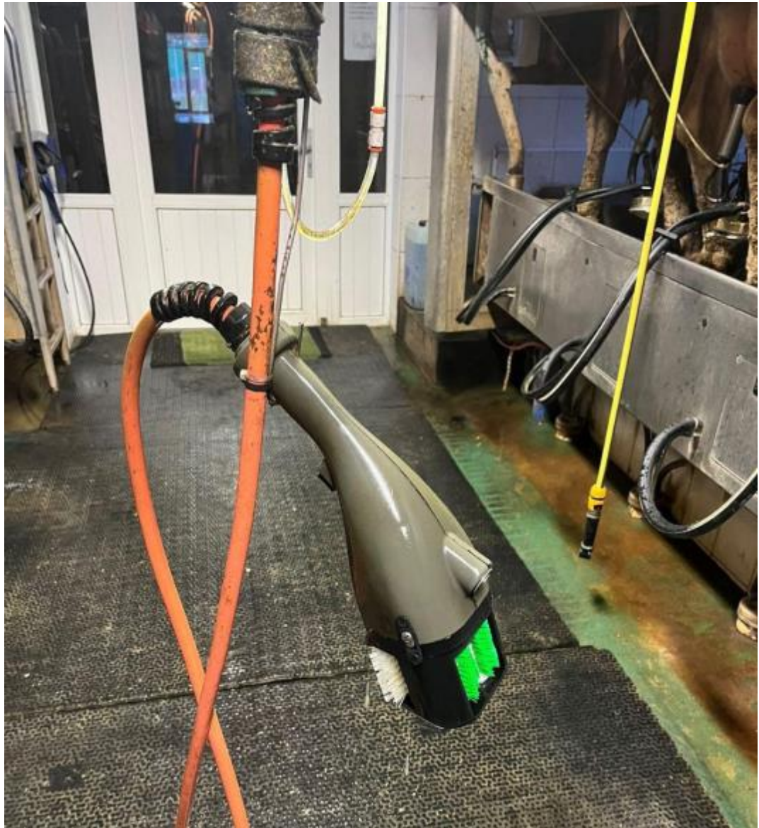
Рис. 19. Пристрій - скрубер для миття дійок перед доїнням корів
