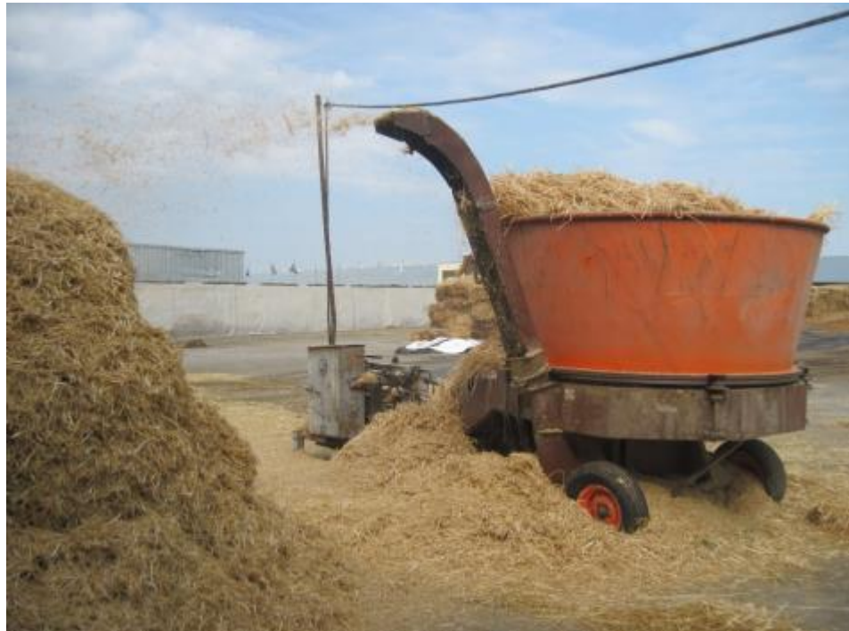
Рис. 17. Подрібнювач грубих кормів – ротогрін
