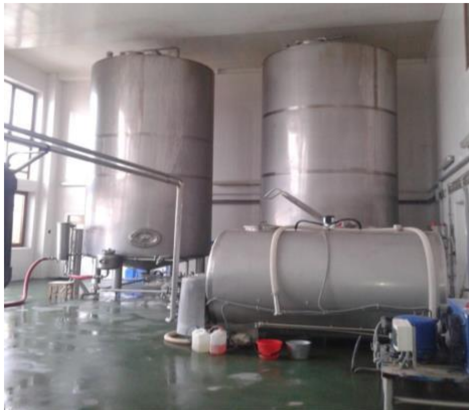
Рис. 23. Резервуар для зберігання молока
