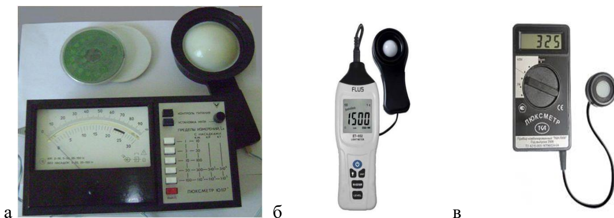
Рис.1.7. Люксметри: а – Ю-116; б – ET-932; в –ТКА-Люкс (з мережі «Інтернет»)
