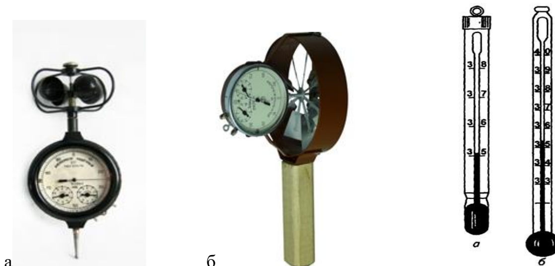
Рис. 1.5. анемометри: а – крильчатий; б – чашковий; кататермометри: а – циліндричний; б – кульковий (з мережі «Інтернет»)
