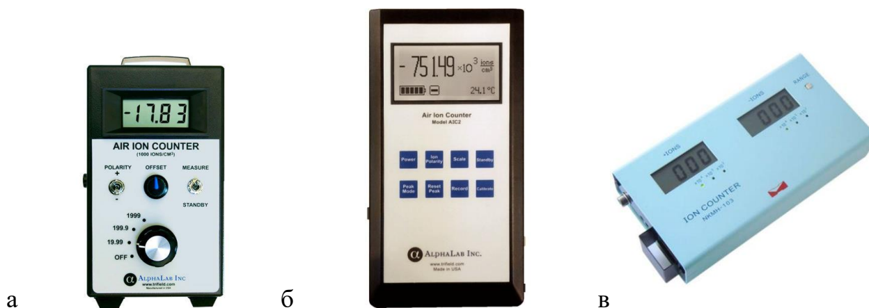
Рис. 1.12: а – Air Ion Counter (AIC); б – MAC-01, в – N-он НКМН-103 (з мережі «Інтернет»)
