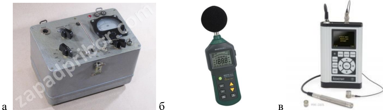
Рис. 1.11. Типи шумомірів: а – ШЗ - М; б – MASTECH; в – АСИСТЕНТ S (з мережі «Інтернет»)
