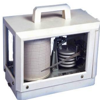
Рис. 1.2. а – барометр-анероїд; б – барограф; в – електронний барометр Testo 511 (з мережі «Інтернет»)
