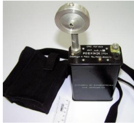
Рис.1.9. а – касети, алонжі та фільтри АФА; б – електроаспіратор; в – фотоелектричний лічильник пилу АЗ –5; г – вимірювач концентрації пилу ВКП (з мережі «Інтернет»)
