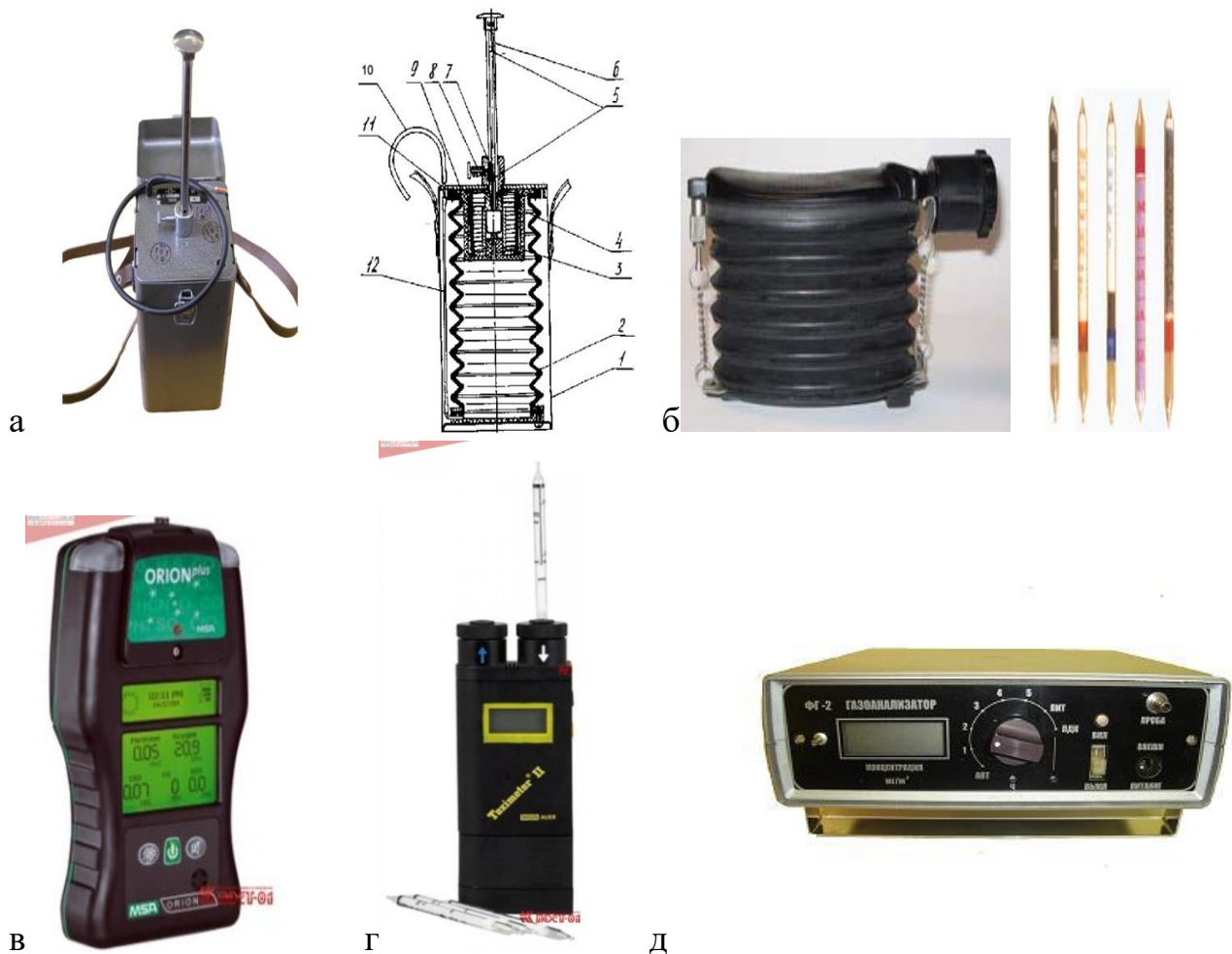
Рис.1.14. а – газоаналізатор УГ-2; б – аспіратор АМ-5 індикаторними трубками; в – ORION plus; г – Тохіметр II; д – газоаналізатор ФГ-2 (з мережі «Інтернет»)
