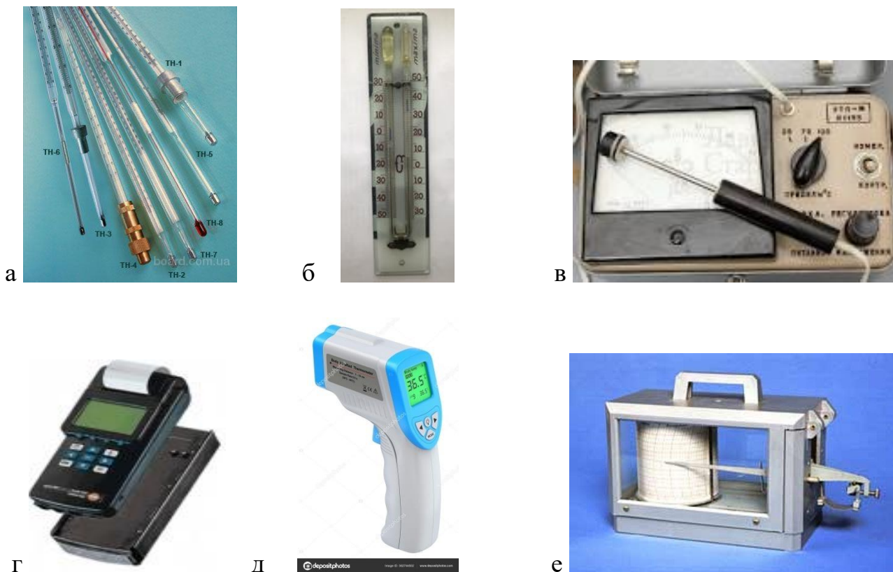
Рис.1.1. Типи термометрів: а – ртутні та спиртові; б – ртутно-спиртові (комбіновані); в – електричні; г – електронні; д – пірометр; е –термограф (з мережі «Інтернет»)
