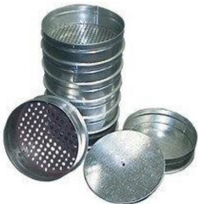
Рис. 4.2: а – сита для механічного аналізу ґрунту; б – міні-лабораторія ґрунту (з мережі «Інтернет»)
