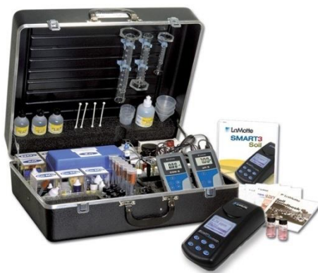
Рис. 4.2: а – сита для механічного аналізу ґрунту; б – міні-лабораторія ґрунту (з мережі «Інтернет»)
