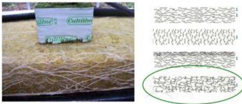
Рис. 1. Мати з базальтових волокон, отримані за X-fibre технологією
