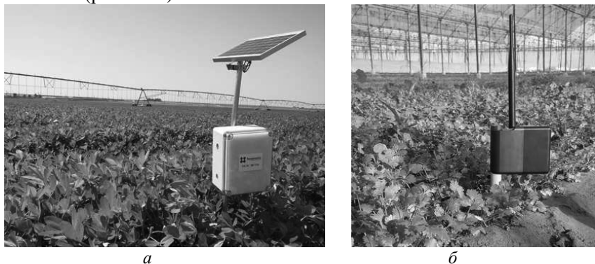
Рисунок 13.9 – Автономна тензометрична станція онлайн (а) і безпроводний тензіометр (б) компанії Tevatronic Ltd
