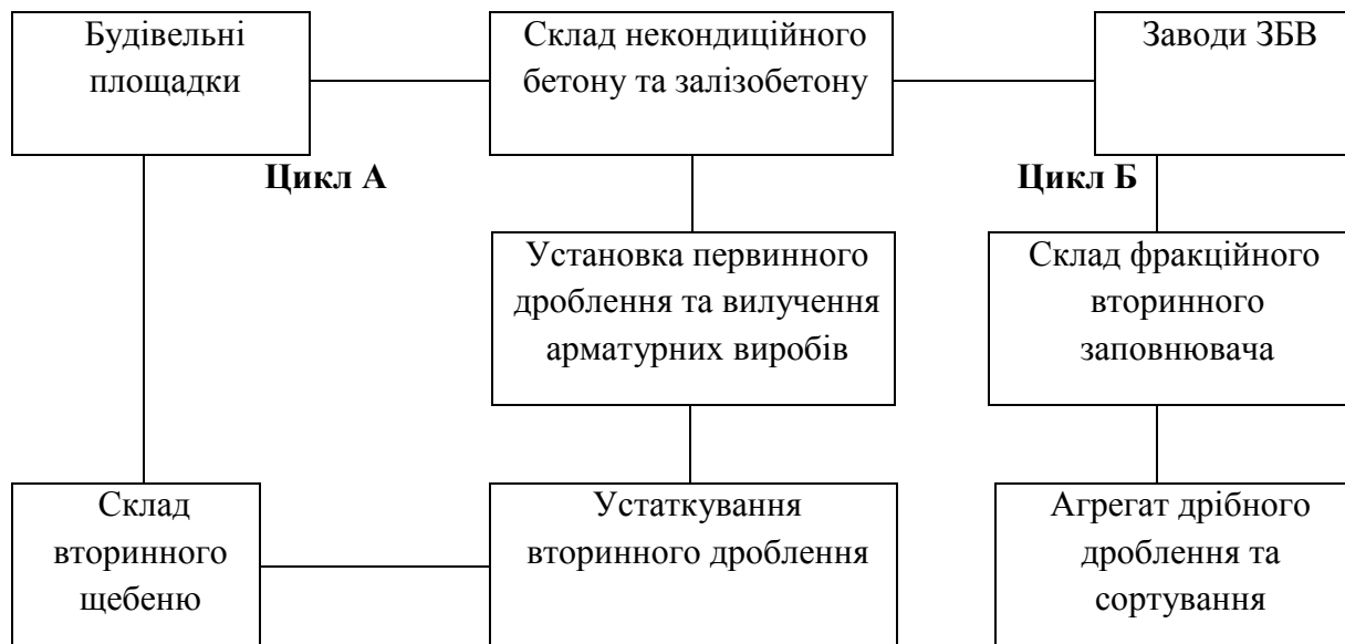
Рисунок 1 – Принципова схема роботи полігону (майданчика)
