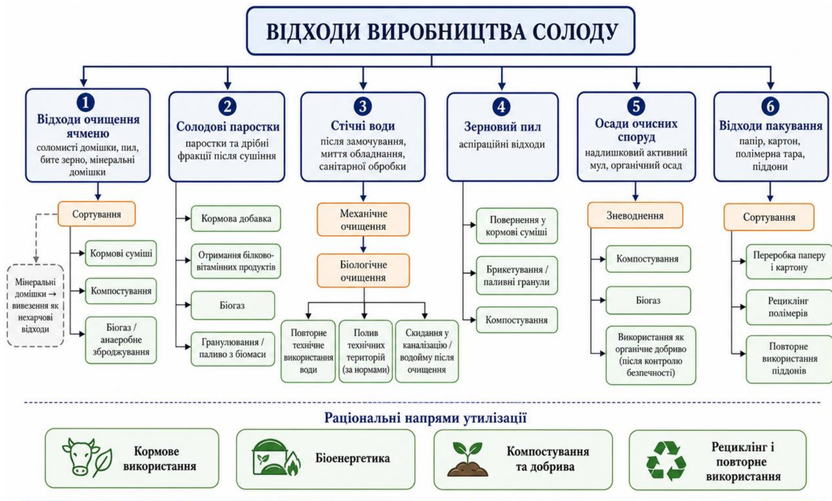
Рисунок 5.2 – Загальна схема утилізації відходів виробництва солоду
