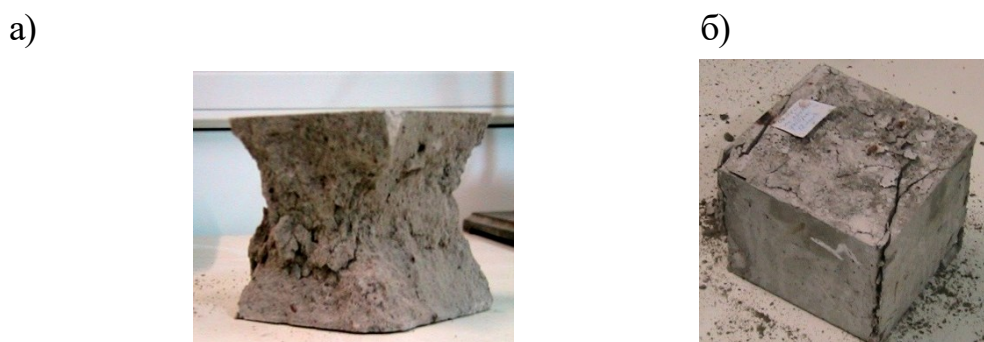
Рис.3. Характер руйнування зразків: а) – неармованих; б)- армованих поліпропіленовими волокнами.
